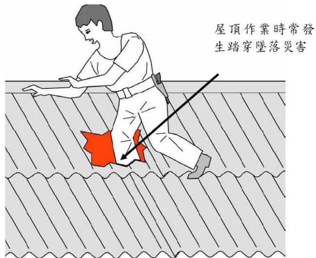
圖 6 屋頂踏穿墜落職災
