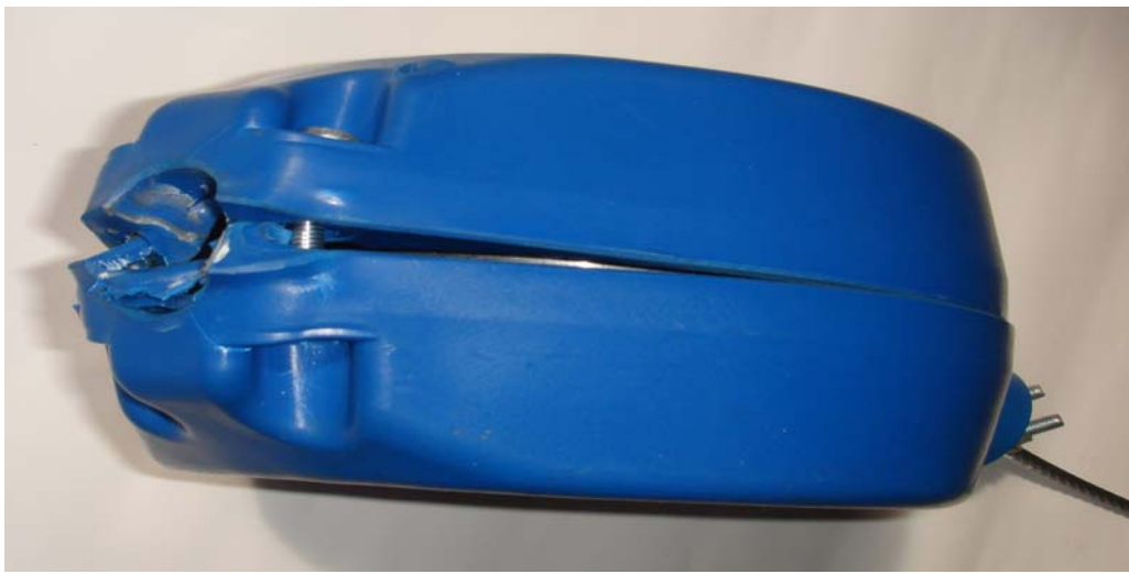
圖 45 B 廠牌吊柄處斷裂
