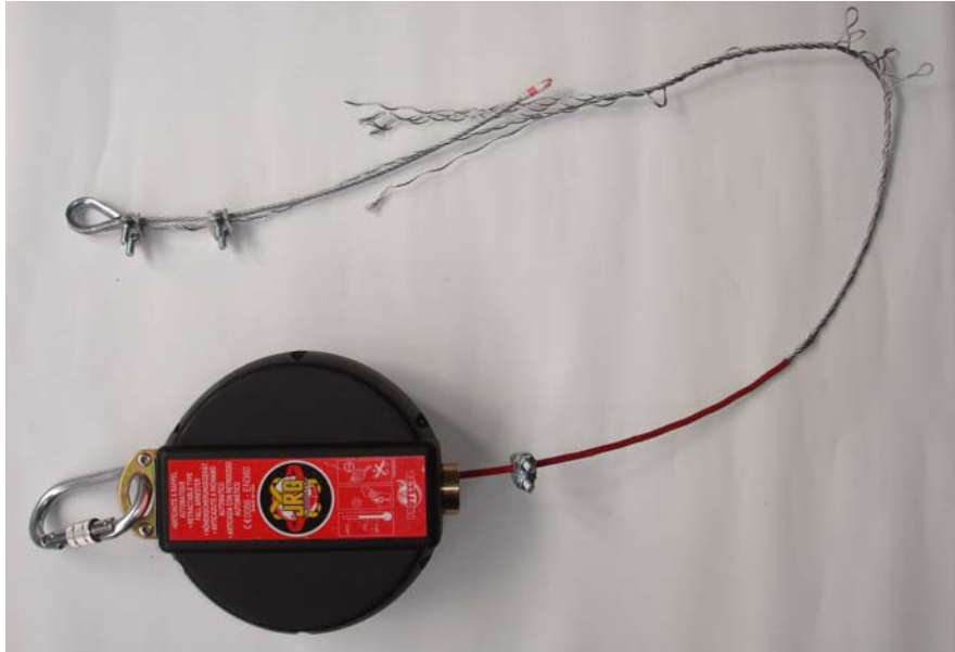
圖 49 H 廠牌鋼索斷裂
