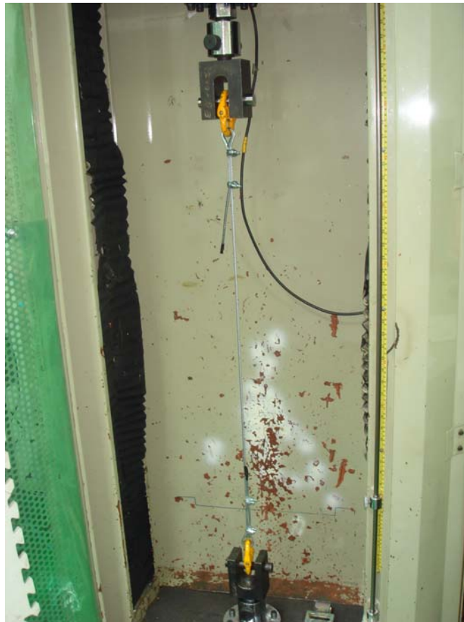
圖 51 鍍鋅鋼與不鏽鋼拉伸試驗
