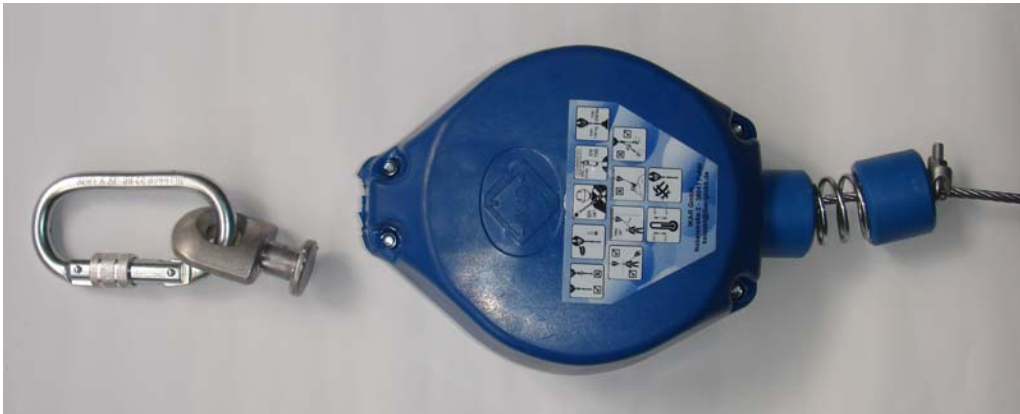
圖 44 B 廠牌吊柄處斷裂
