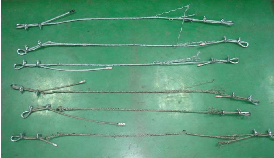
圖 52 鍍鋅鋼與不鏽鋼材質拉伸試驗結果
