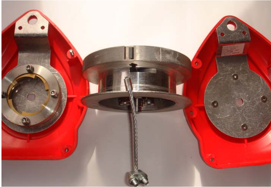
圖 47 E 廠牌鋼索聯結處脫落
