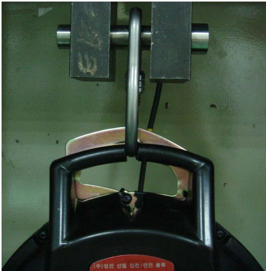
圖 48 L 廠牌吊柄處斷裂
