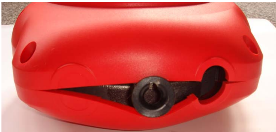
圖 46 E 廠牌出口端損壞
