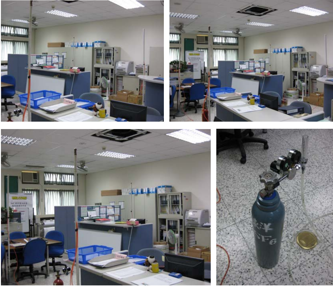
圖 40 作業環境通風換氣效率現場測試狀況圖
