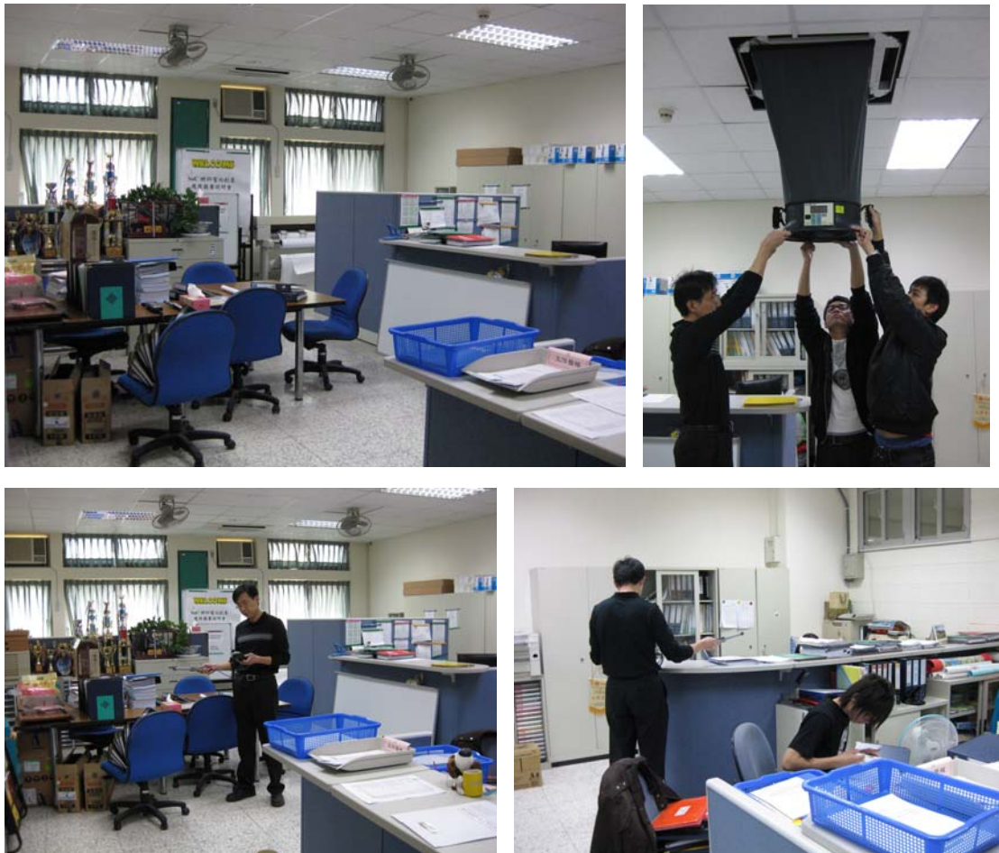
圖 38 作業環境通風效率現場檢測狀況圖
