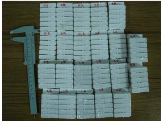
圖 7 門縫調整所使用之不同厚度墊片
