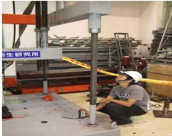
圖 6 拉拔機台水平校正示意圖
