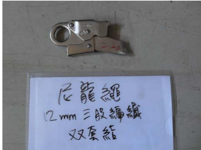
圖 10 掛鉤損壞示意圖
