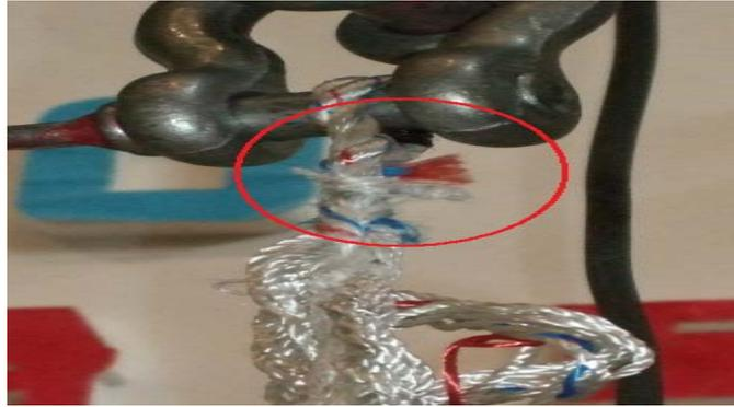
圖 29 斷裂位置較接近於錨定點
