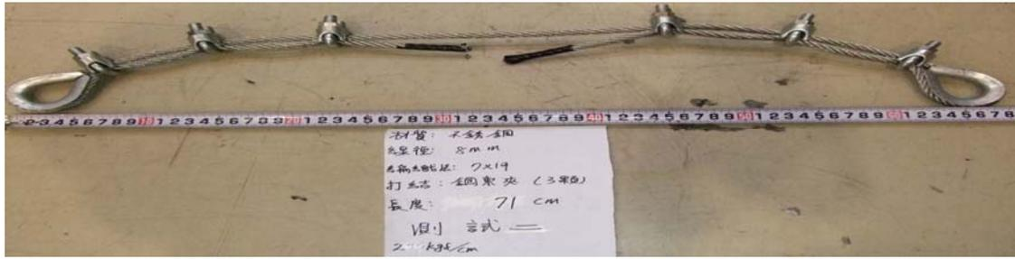
圖 55 鋼索夾鎖鋼索之長邊示意圖
