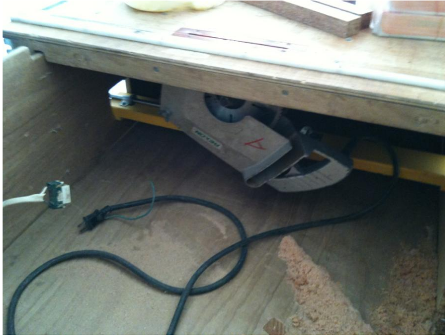
圖 22 氣罩式集塵之切割台木箱內部
