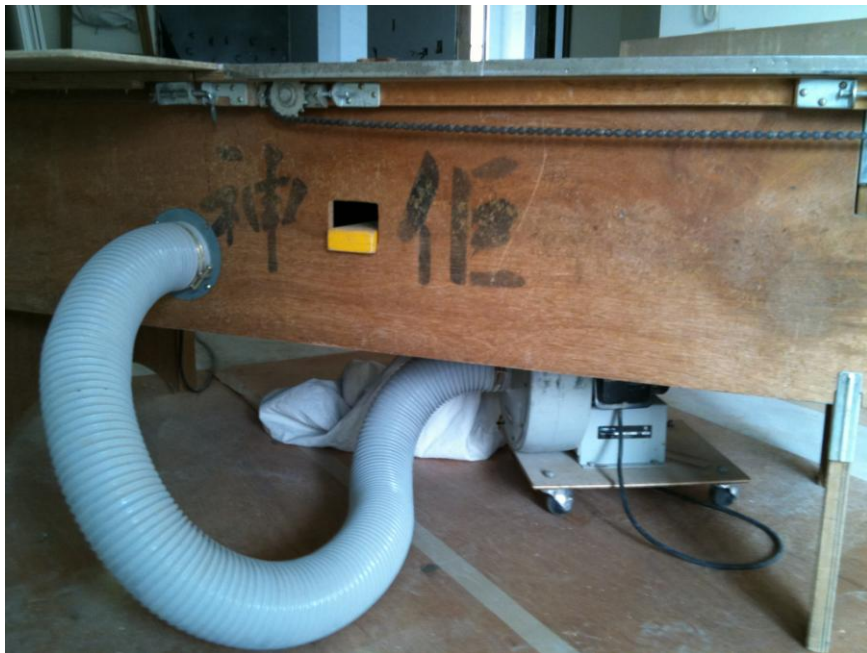
圖 23 氣罩式集塵之切割台連結集塵導管方式
