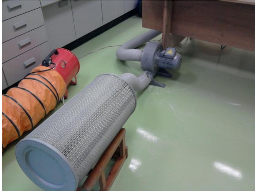
圖 53 裝潢木工作業時最適的集塵裝置
