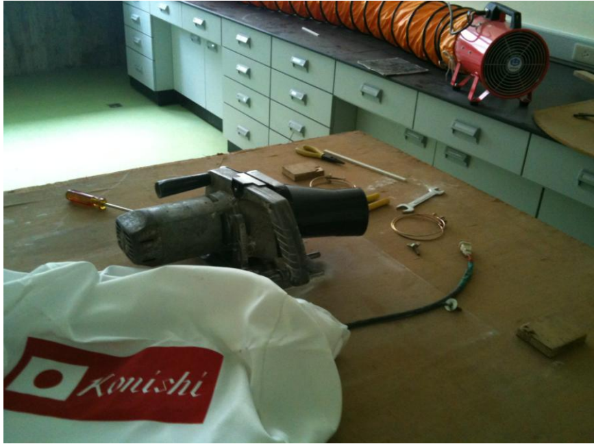
圖 20 圓盤鋸安裝集塵導管用的側蓋板
