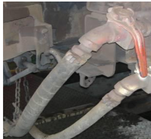
輔助電源電纜連接端
