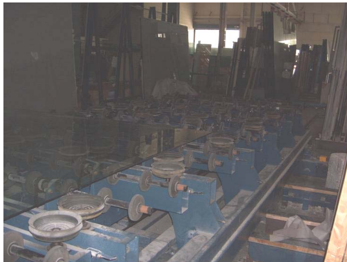
圖 68 真空吸取輸送裝置未裝設警示裝置.
