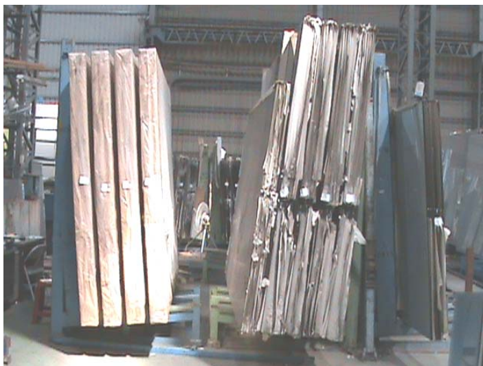
圖 92 玻璃放置架未設置防倒塌措施.
