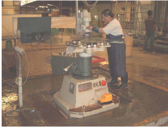
圖 71 鑽孔機未接地.
