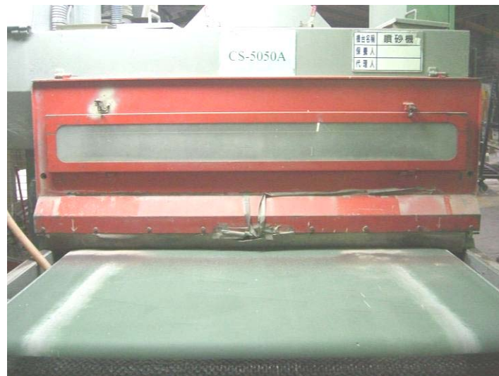
圖 79 噴砂機缺失改善措施.
