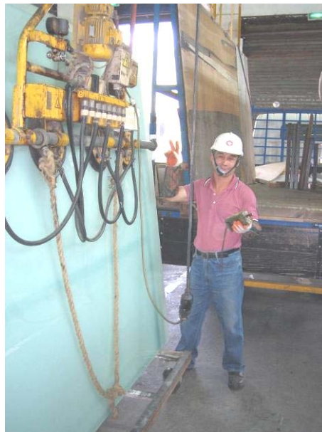
圖 65 固定式起重機作業佩戴安全帽.
