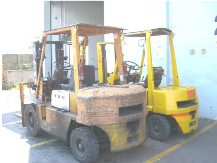
圖 86 堆高機未標示最大荷重.
