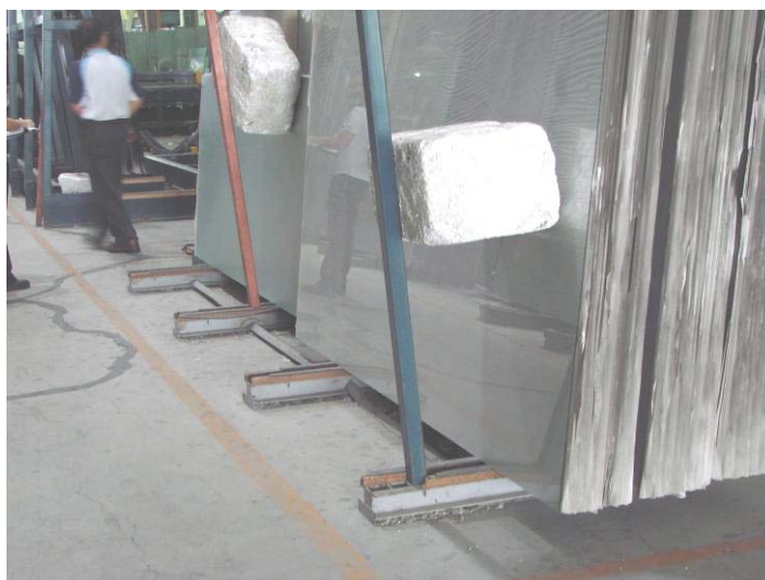
圖 93 玻璃放置架倒塌改善措施.
