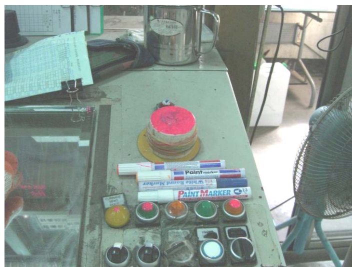
圖 91 緊急制動開關改善措施.
