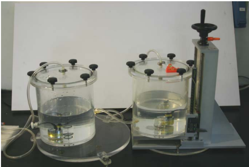
圖33 本節改良實例版雙腔式微壓訊號產生器運作實況
