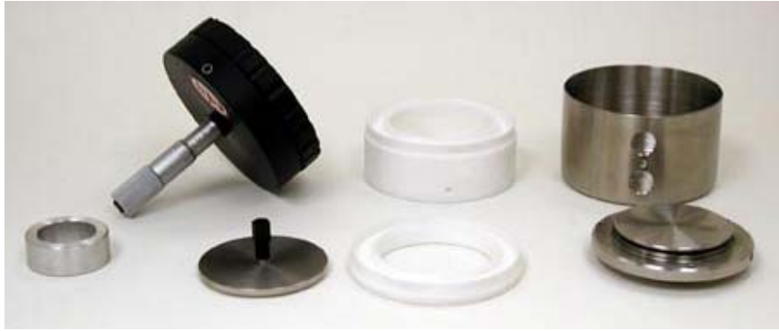
圖 18 體積阻抗儀器組件
