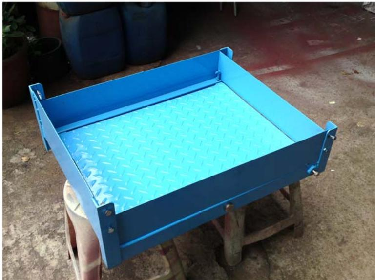
圖 122 作業平臺與旋轉護欄結合
