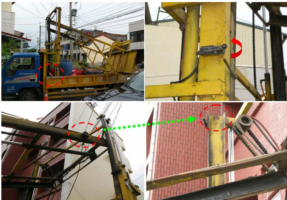
圖 28 從事交通標誌設立/更改作業因油壓桿推昇超過極限導致墜落死亡
