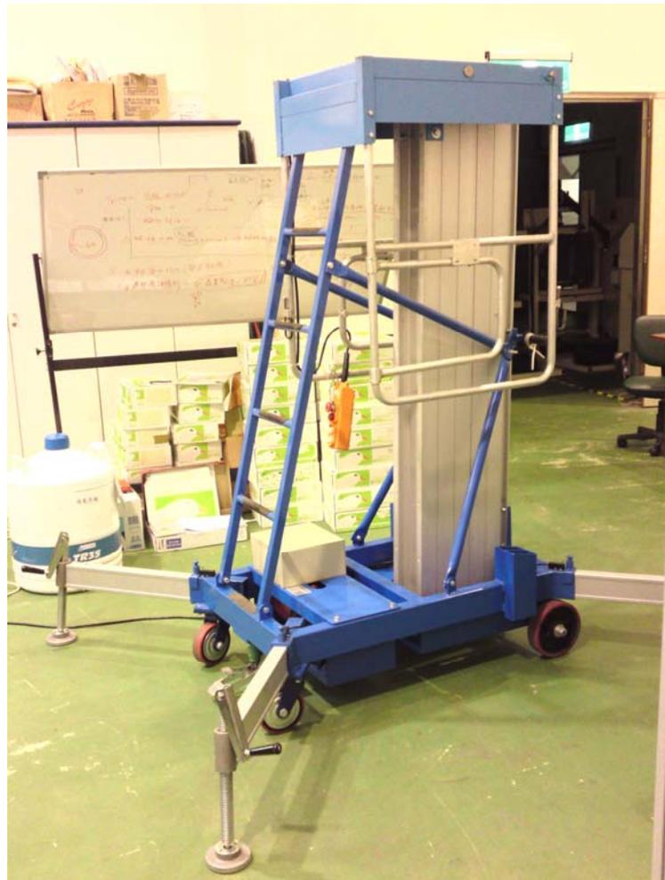
圖 131 懸空作業輔助平臺原型機
