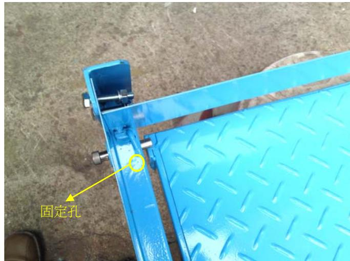
圖 123 作業平臺與旋轉護欄之卡固
