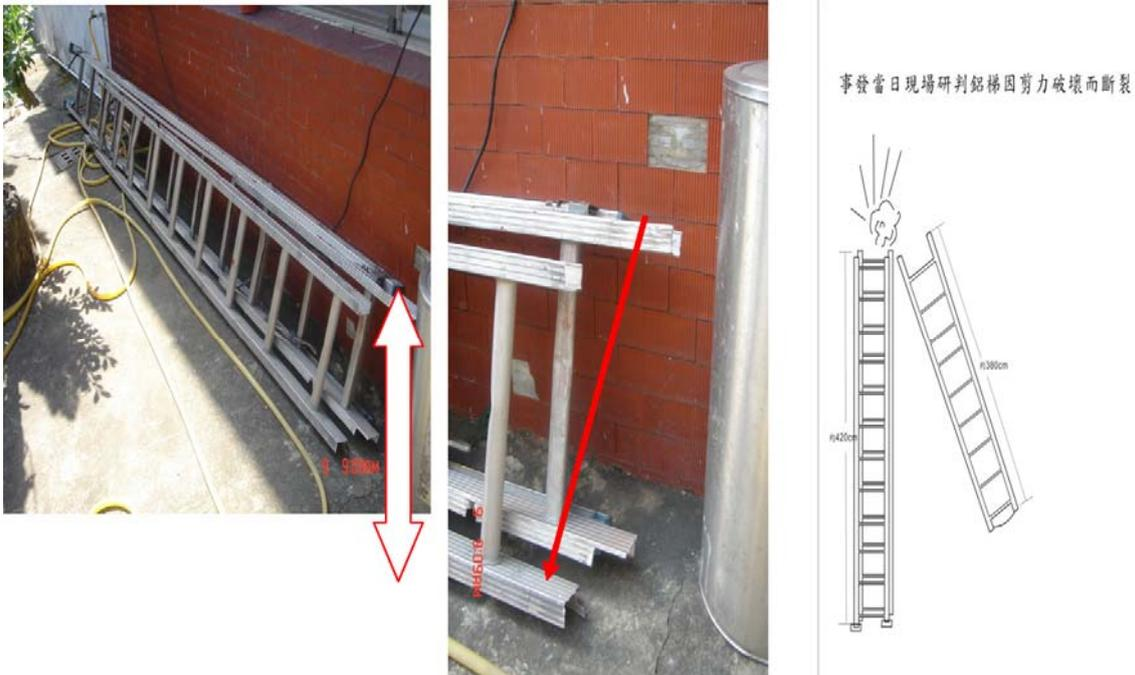
(b)勞工墜落地面時斷裂之鋁梯(長節約 420 公分,短節約 380 公分)
