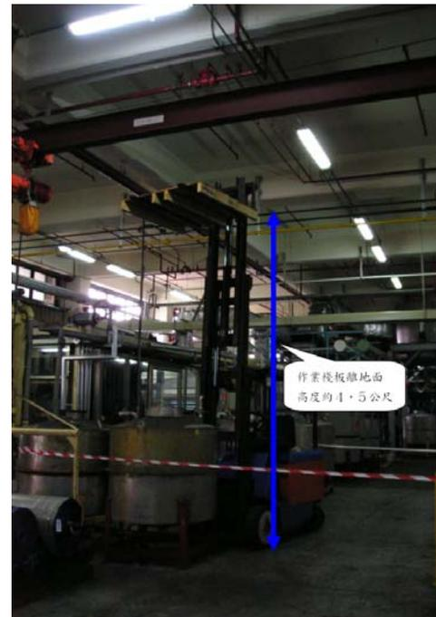
(a) 災害發生時罹災者正與同事從事上膠區 O<sub>2</sub> 機線卸捲段上方消防管線一齊開放閥之更換作業，照片中左上方之閥肇災前已更換完成，照片中右上方之閥為肇災當時正在更換之閥
