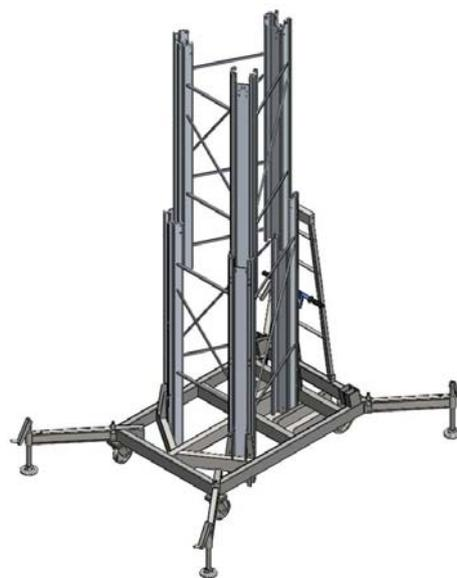
圖 48 懸空作業輔助平臺設計一機構示意圖
