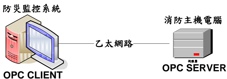
圖27 透過消防主機電腦連線
