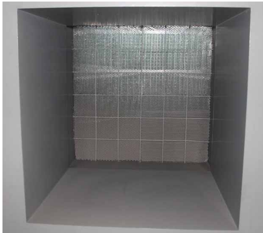
圖41 校正風洞的出風口蜂巢結構與阻力網特寫
