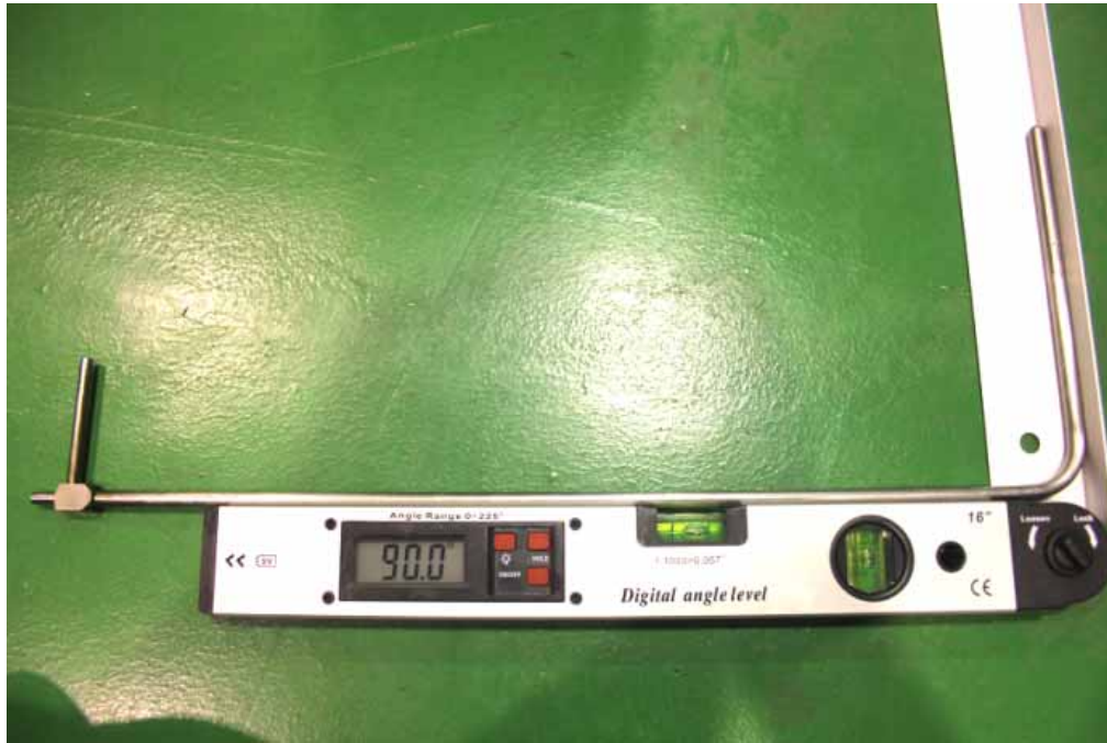
圖34 研究人員於實驗進行前覆核皮托管的姿態角
