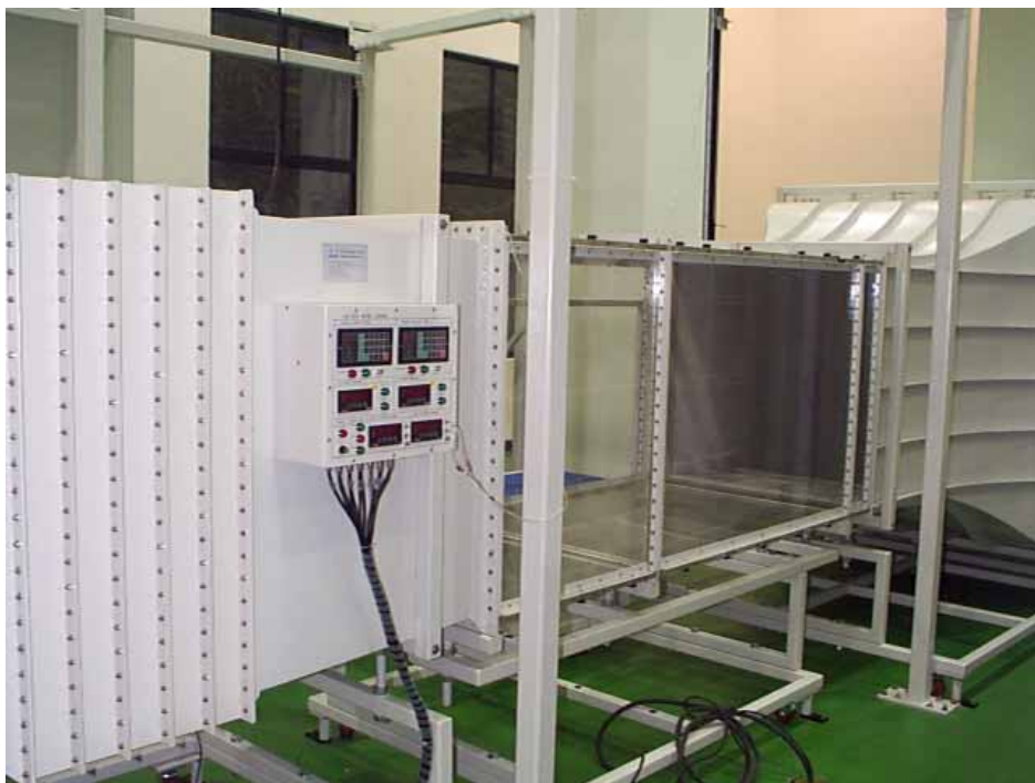
圖11 吸氣式開迴路風洞：自右起分別為束縮段、測試段與後整流段
