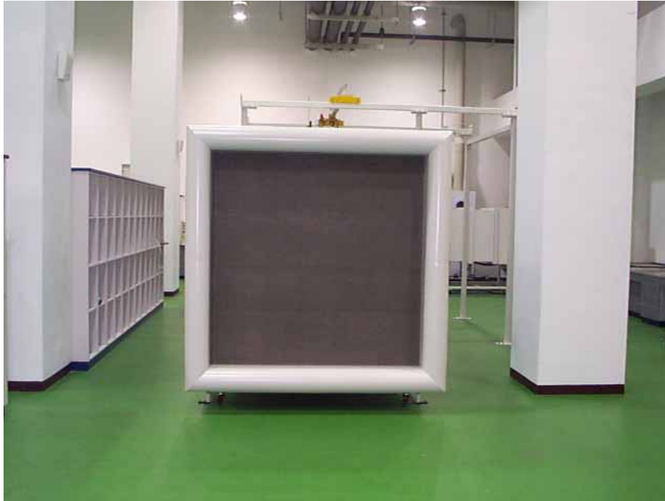
圖10 吸氣式開迴路風洞：空氣吸入口外觀
