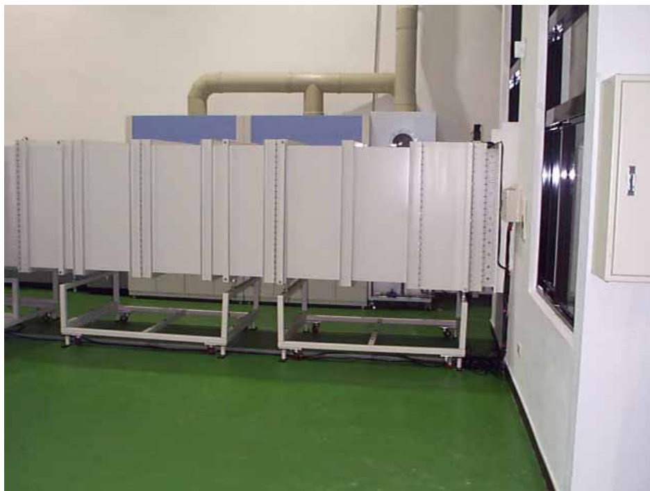
圖15 吸氣式開迴路風洞：風洞出口段特寫（右方為出口）
