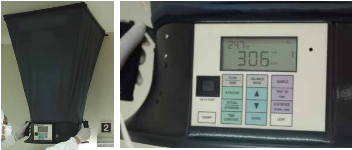
圖2 某罩式風量計的風罩外觀與儀表鍵盤（廠牌符號已塗銷）
