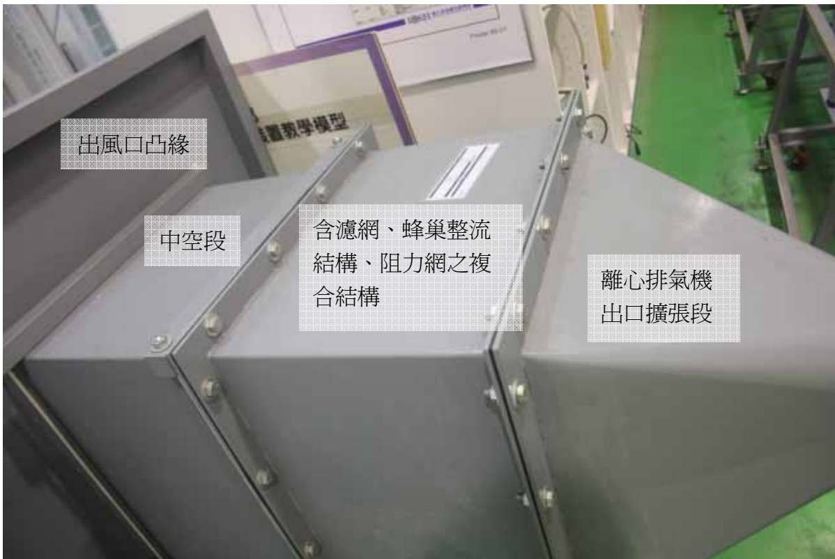
圖39 校正風洞的出口部分外觀特寫
