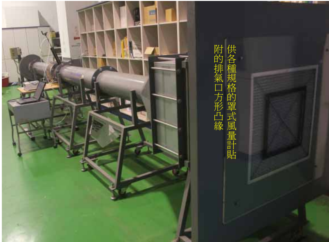
圖28 設備外觀：右為可調整開口面積的吸氣入口凸緣)
