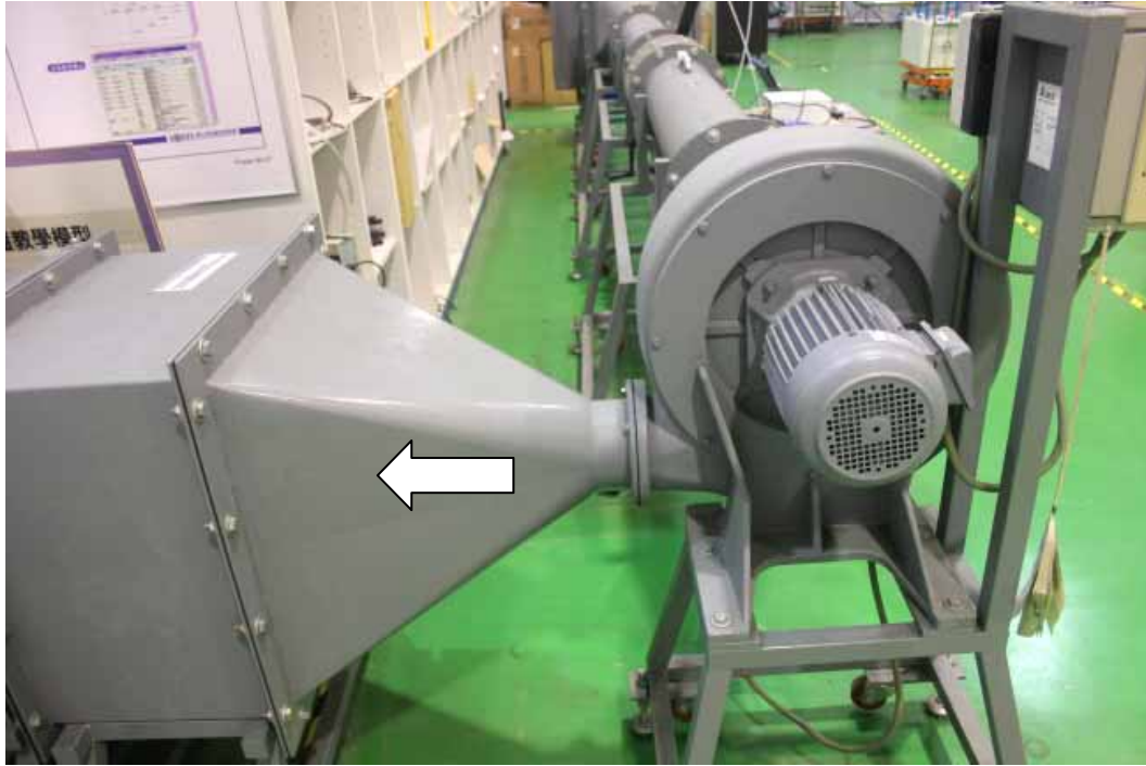
圖38 校正風洞的離心排氣機與出口擴張段
