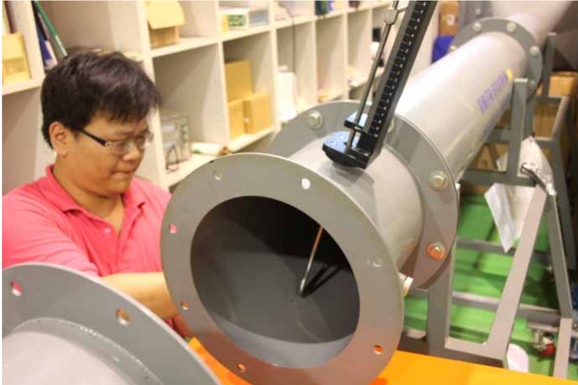
圖32 忙碌的研究人員正在覆核皮托管於監測段中的插入深度與安裝姿態
