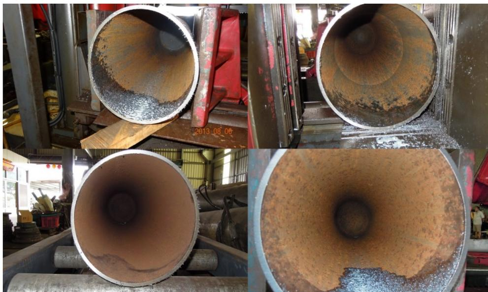
圖 17 老舊氧氣鋼瓶內部圖之二
