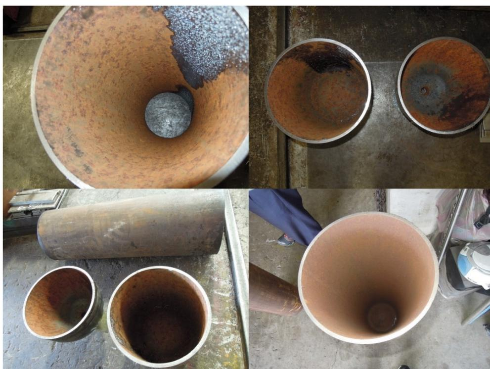
圖 18 老舊氧氣鋼瓶內部圖之三
