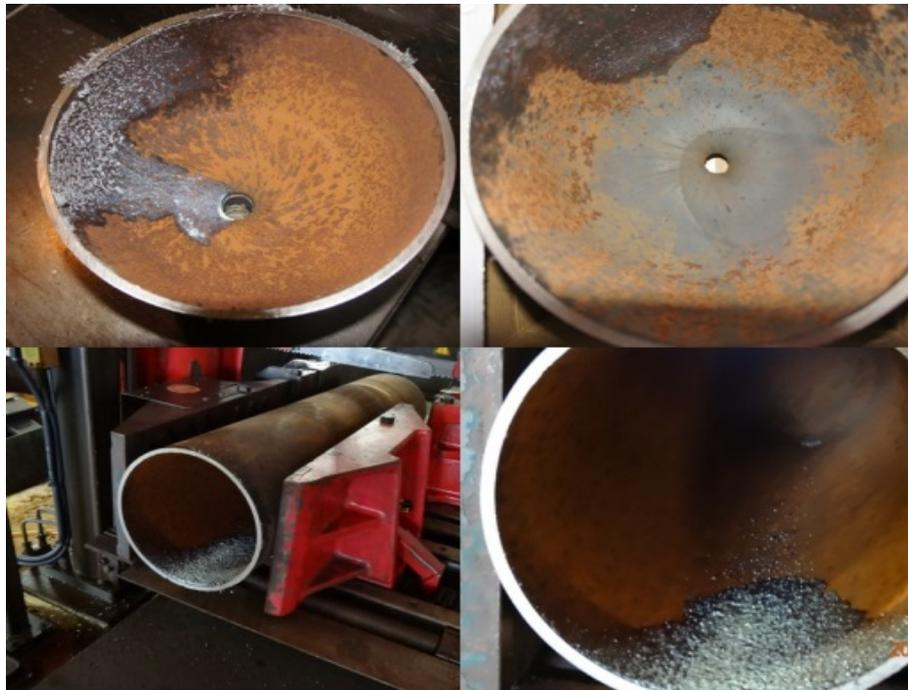
圖 16 老舊氧氣鋼瓶內部圖之一
