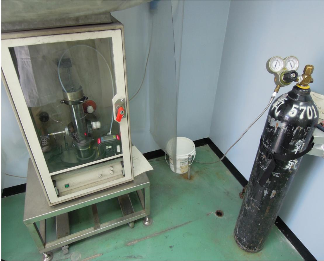
圖 8 改裝後氧氣環境下之最小點火能量試驗裝置
