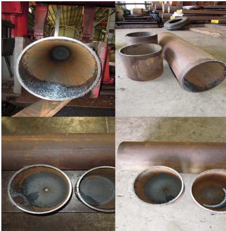
圖 20 老舊氧氣鋼瓶內部圖之五
