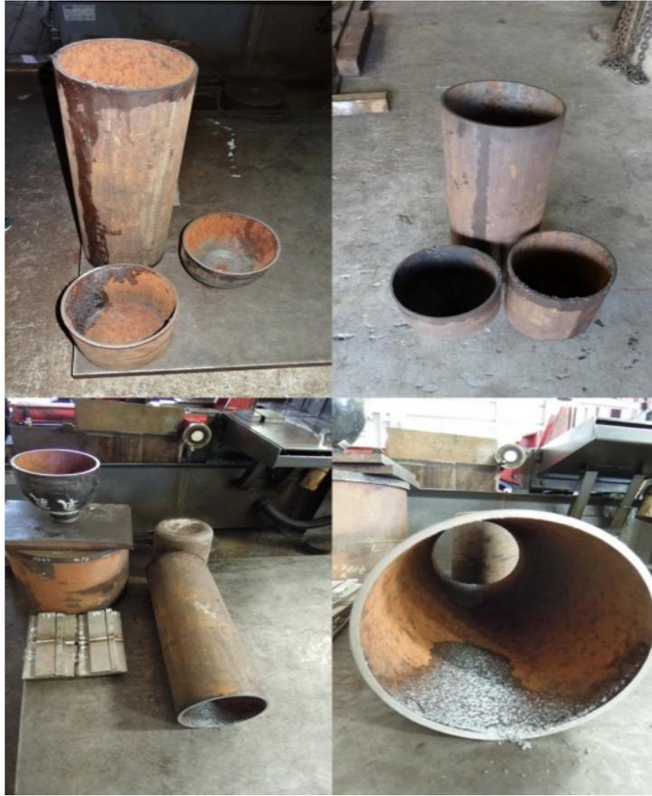
圖 19 老舊氧氣鋼瓶內部圖之四
