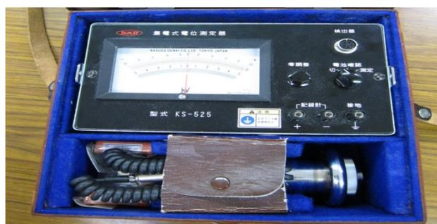
圖 7 集電式電位測定器
