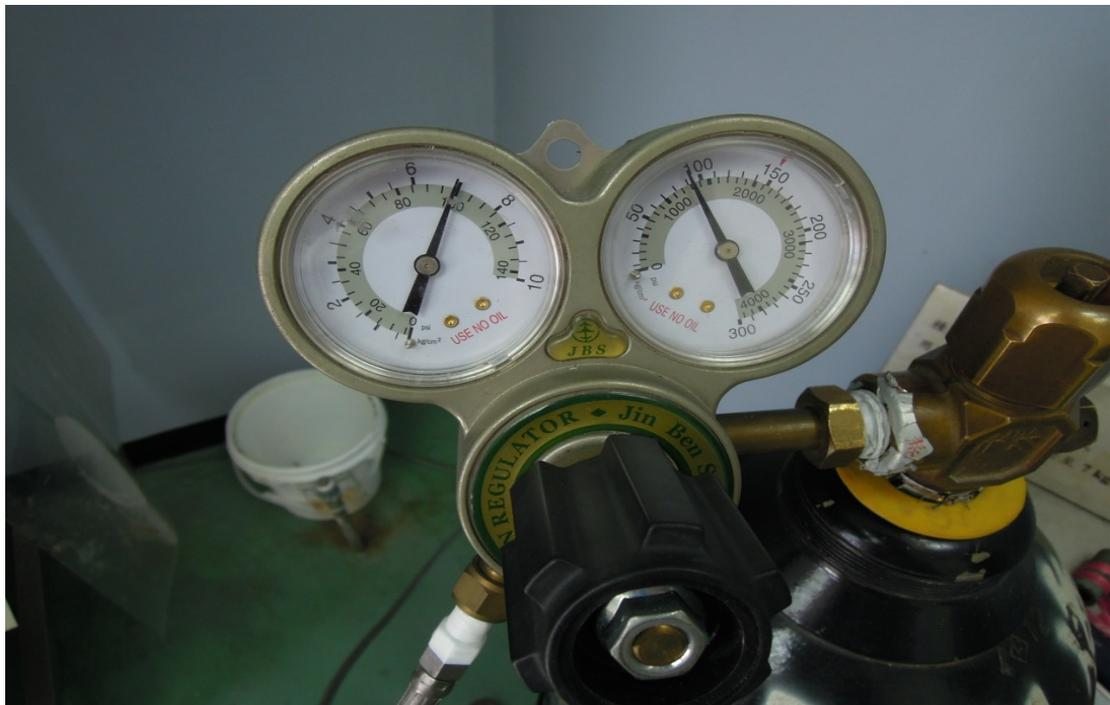
圖 9 壓縮氧氣鋼瓶之壓力
