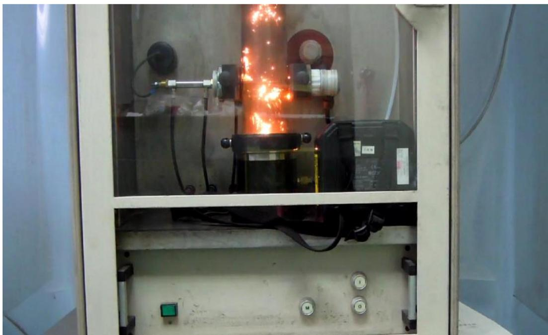
圖 13 Fe powder 35 nm 粉塵雲引燃示意圖
