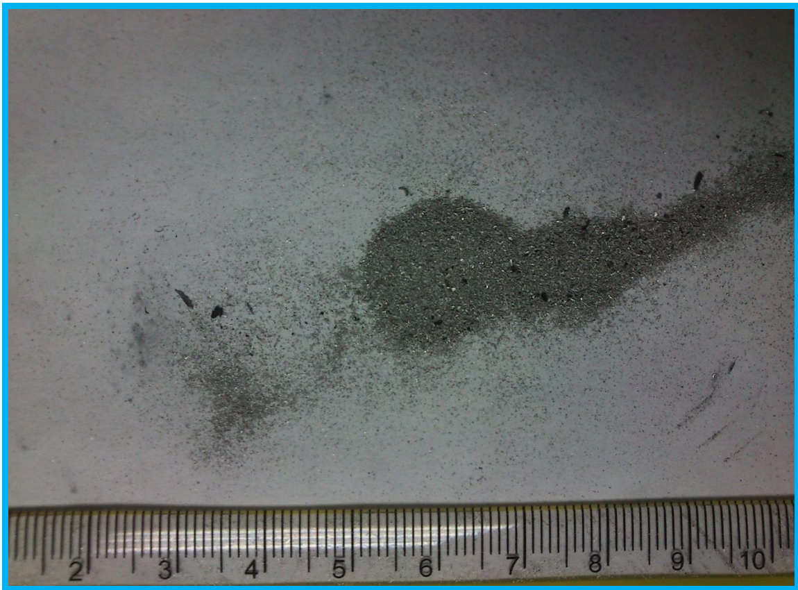
圖 30.重量 1500mg (1.25g/dm 3 ) 鋁鎂合金粉塵對點火能量(1 mJ)之 1.2L 哈特曼測試結果
