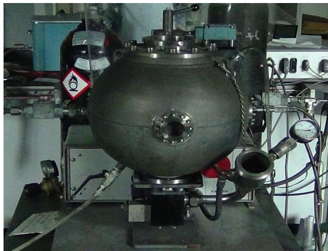
圖 7. 20L 爆炸鋼球配置圖
