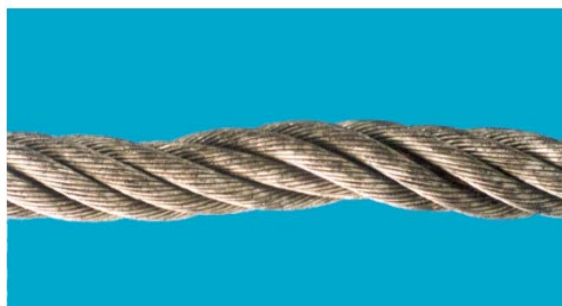
圖 101 纜徑局部縮小 Local reduction in rope diameter
