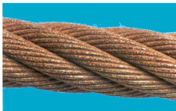
圖 109 外部腐蝕 External corrosion
