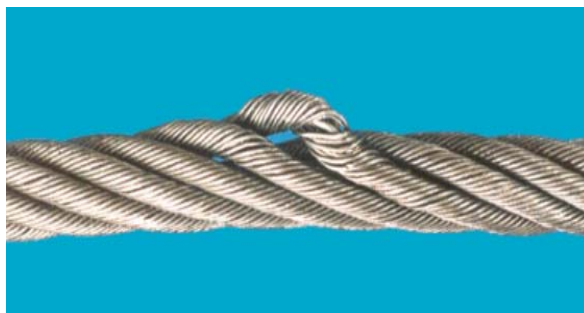
圖 102 繩股擠出/變形 Strand protrusion/distortion
