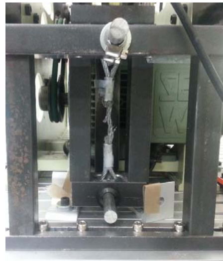
圖 117 高速疲勞耐久試驗機 HCF 與鋼索夾持情形
