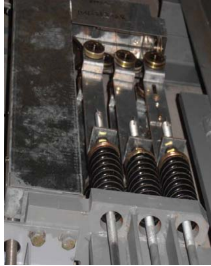
圖 67 鋼索固定端連接到感測鋼索受力裝置
