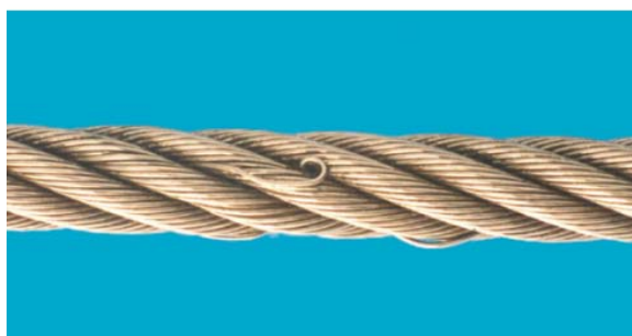
圖 99 鋼絲擠出 Wire protrusion
