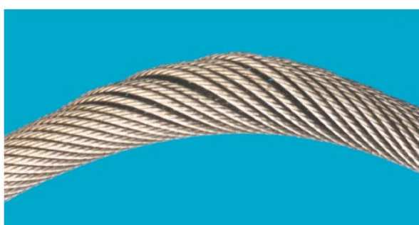
圖 107 籠狀畸變 Basket deformation
