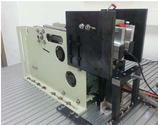
圖 117 高速疲勞耐久試驗機 HCF 與鋼索夾持情形
