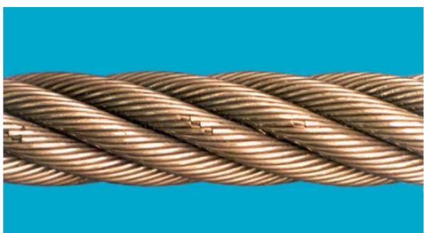
圖 110 朝外層鋼線斷裂 Crown wire breaks
