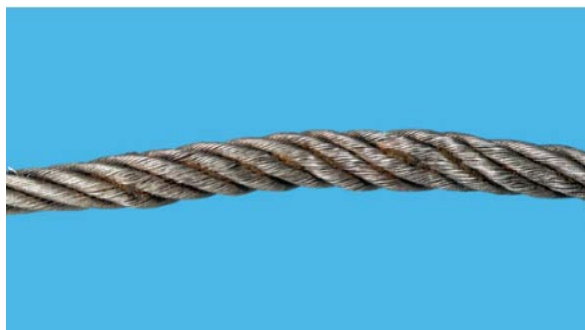
圖 103 局部被壓扁 Flattened portion
