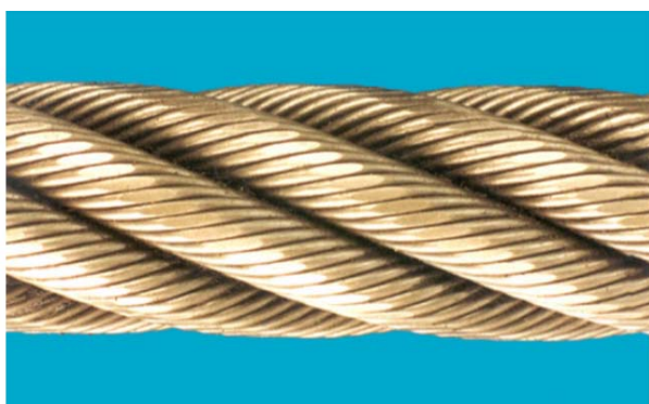
圖 108 外部磨損 External wear
