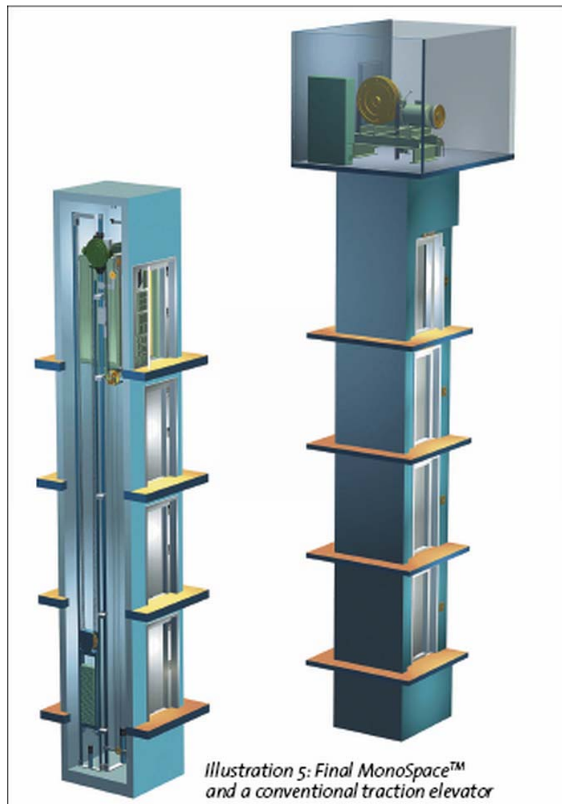
圖 4 傳統馬達槽輪驅動與利用盤型線性馬達驅動升降機比較示意圖 [1]
