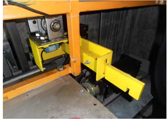
圖 77 鋼結構鎖定裝置
