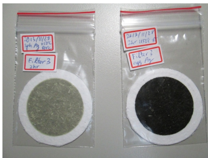
圖 33 濾材經過兩小時的負載後，中心過濾區明顯出現色差。過濾圓球形銀微粒的濾紙(左)過濾區呈淺灰色，濾材纖維仍清楚可見。過濾不規則形銀微粒的濾紙(右)過濾區呈深黑色，表面明顯累積了一層負載物
