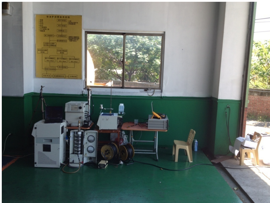
圖 19 架設於柴油車排煙檢測站的儀器設備，有左至右分別為 EEPS、SMPS、MOUDI 與 APM 的電壓轉速控制器
