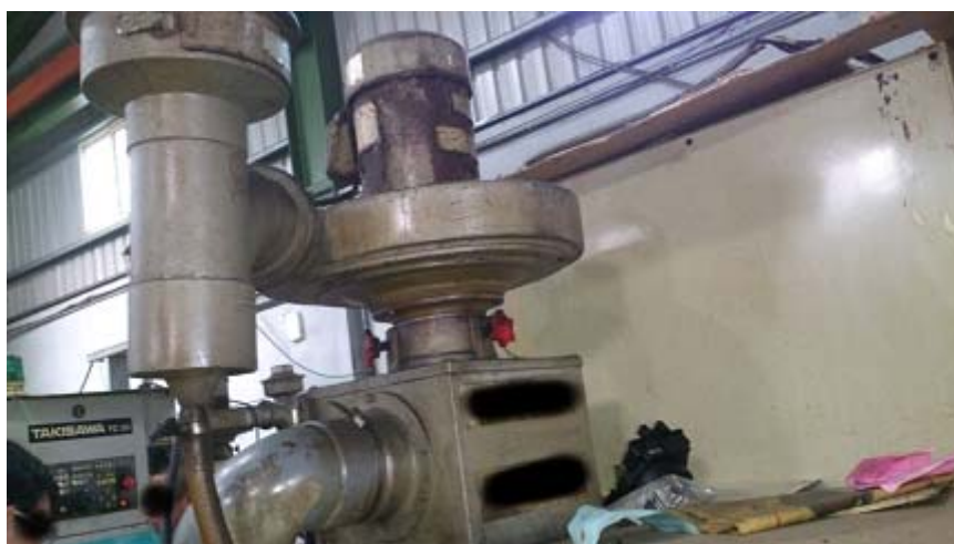
圖 21 B2 廠的橫式高壓二段式油霧回收機
