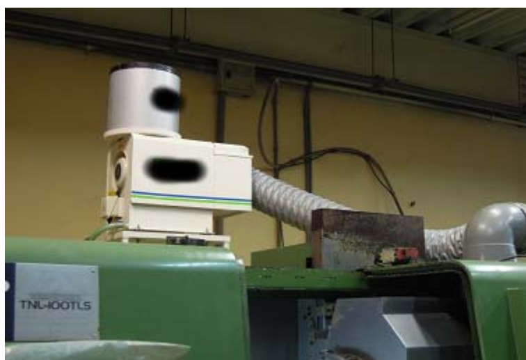
圖 15 A3 廠的油霧回收空氣清淨機
