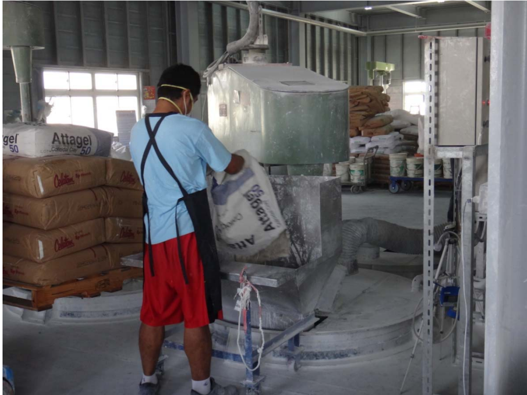
圖 12 B 廠水性塗料之投料攪拌區
