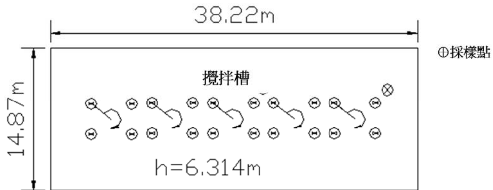
圖 33 D 廠水性塗料製程投料區(攪拌槽)之採樣位置(D1 與 D2)與局部抽氣設備
