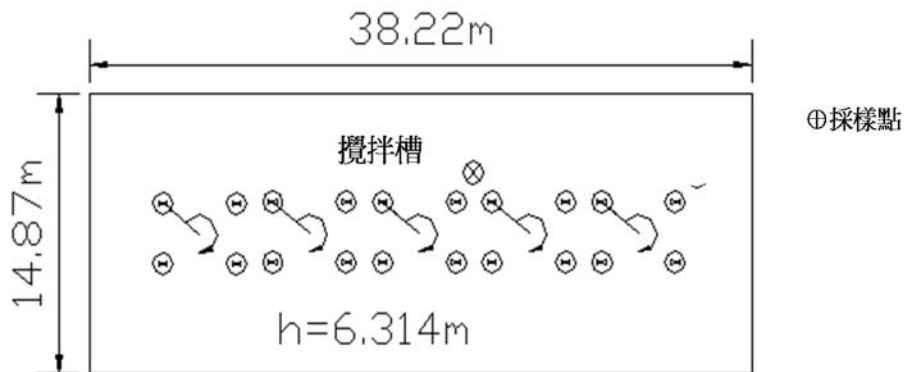
圖 34 D 廠水性塗料製程投料區(攪拌槽)之採樣位置(D3 與 D4)與局部抽氣設備
