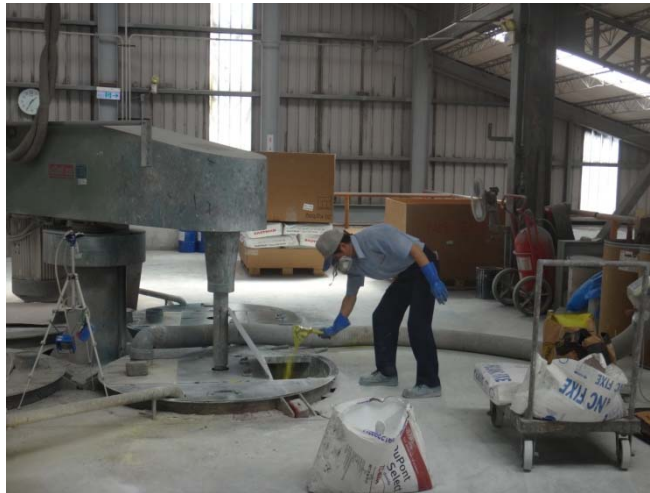
圖 23 油性塗料固定式高速分散機槽投料區
