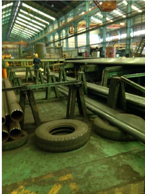
圖 55 鋼管輸送過程相互碰撞及不良品掉落聲響發生處
