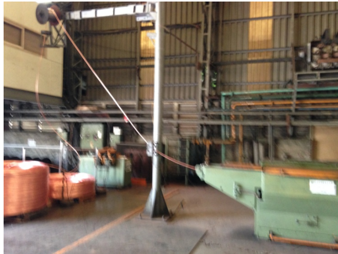
圖 36 老舊粗伸線機
