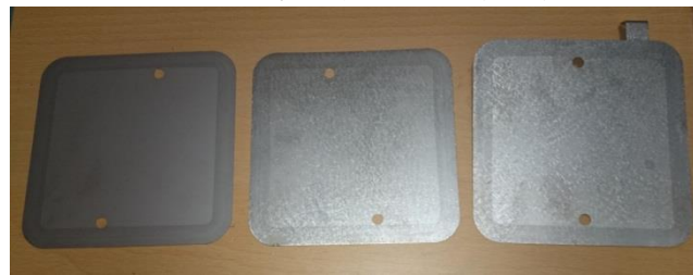
圖 31 不鏽鋼電極，左邊為模組電力引入電極。
