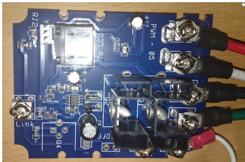
圖 22 經測試確實可以輸出 12V 的 PWM 波形
