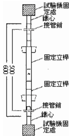
圖 84 續接端之拉力試驗例圖
