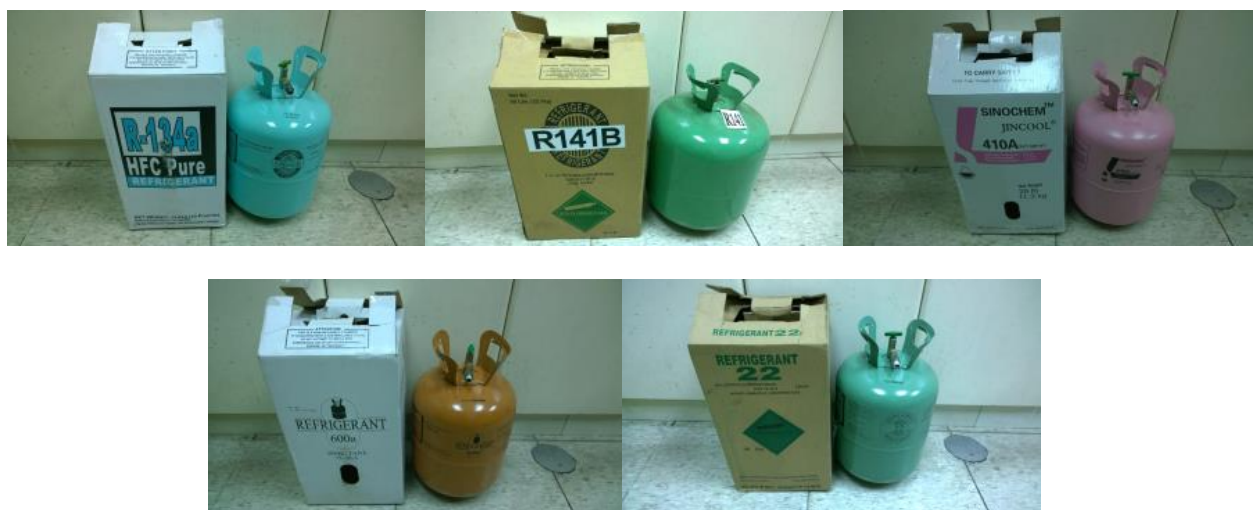
圖 12 一般環保冷媒種類 左上至右下依序為 R-134a, R-141b, R-410a, R-600a, 及 R-22
