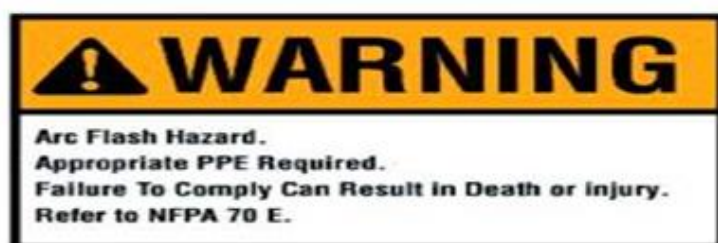
圖 9 美國國家電氣規範要求之電弧閃光危害標記
