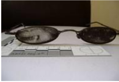
圖 8 電弧造成嚴重燒焦之眼鏡
