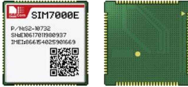
圖 23 感測裝置使用之 SIMCom 公司 SIM7000E 模組之通訊晶片圖示
