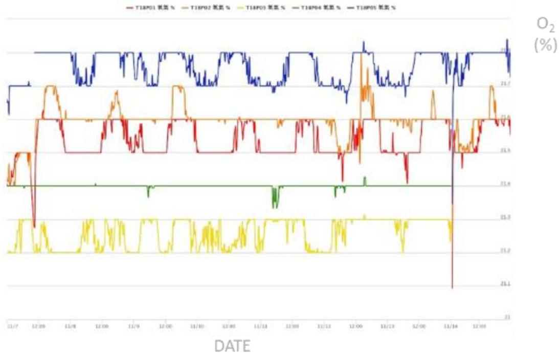
圖 23 不同採樣點以感測器連續七天監測氧氣之濃度分佈圖
