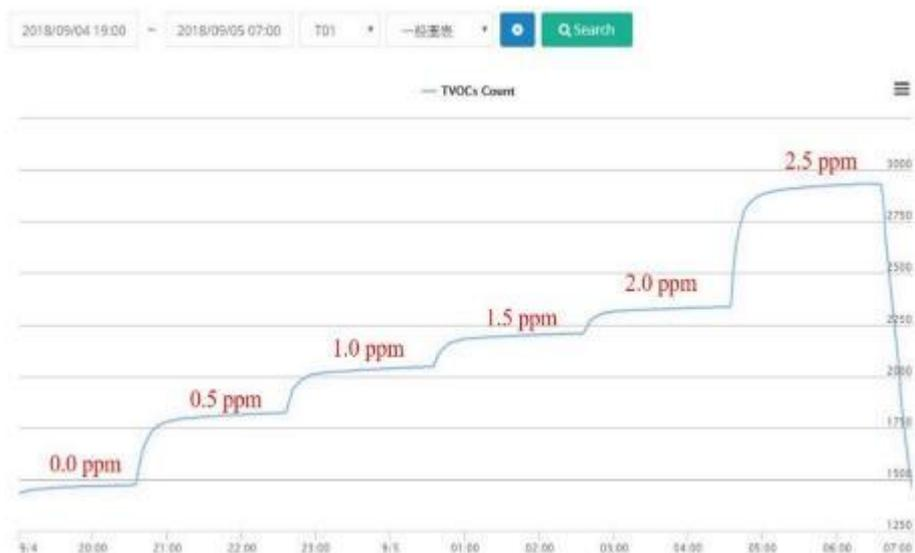
圖 5 總碳氫化合物(TVOCs)感測元件濃度線性測試趨勢圖(單位 Count)
