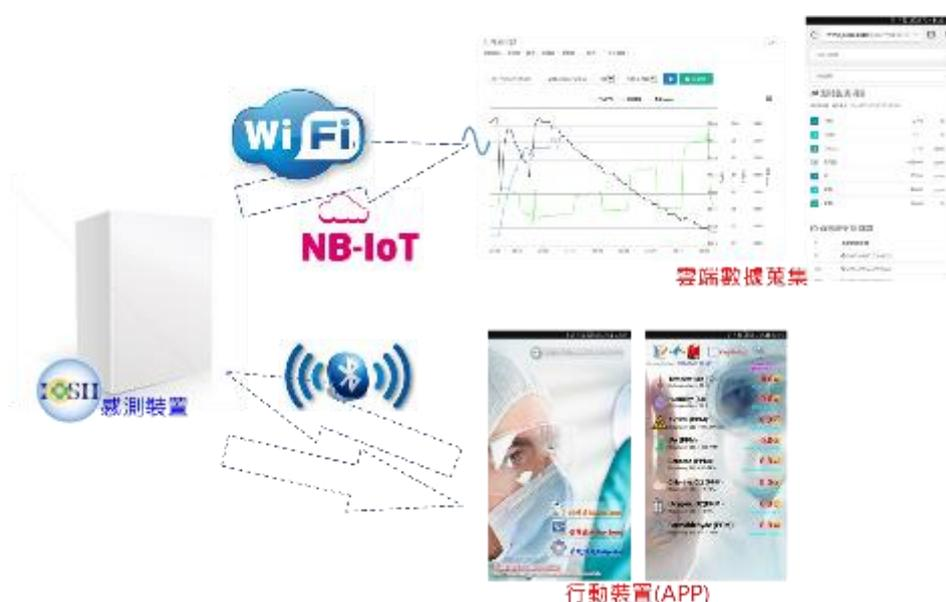
圖 46 感測裝置無線傳輸功能與架構設計示意圖
