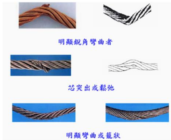
圖 4 鋼索異常狀態示意圖
