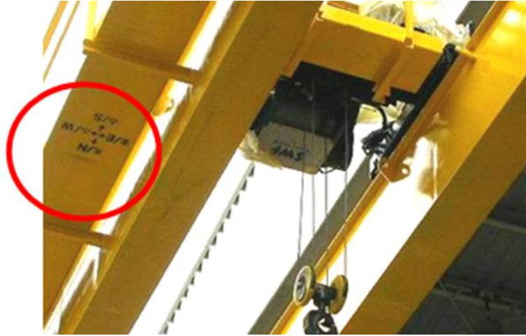
圖 2 固定式起重機標示
