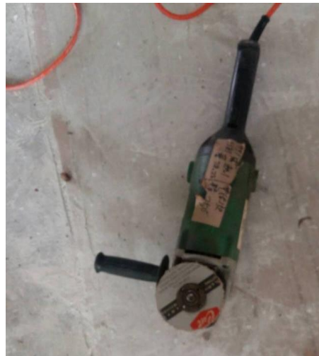
意外劃傷工人的砂輪機。
