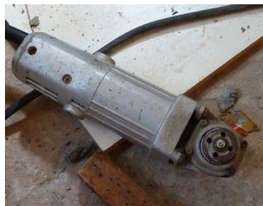
現場研磨機未設置護罩。
