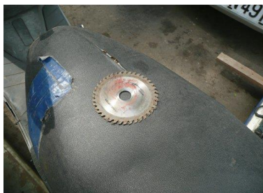
肇事砂輪機鋸片。 (血跡殘留處)
