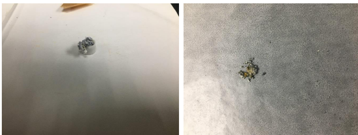
圖 46 A(右)、B(左) 兩鎂合金樣品於 DSC 熱分析實驗後之產物
