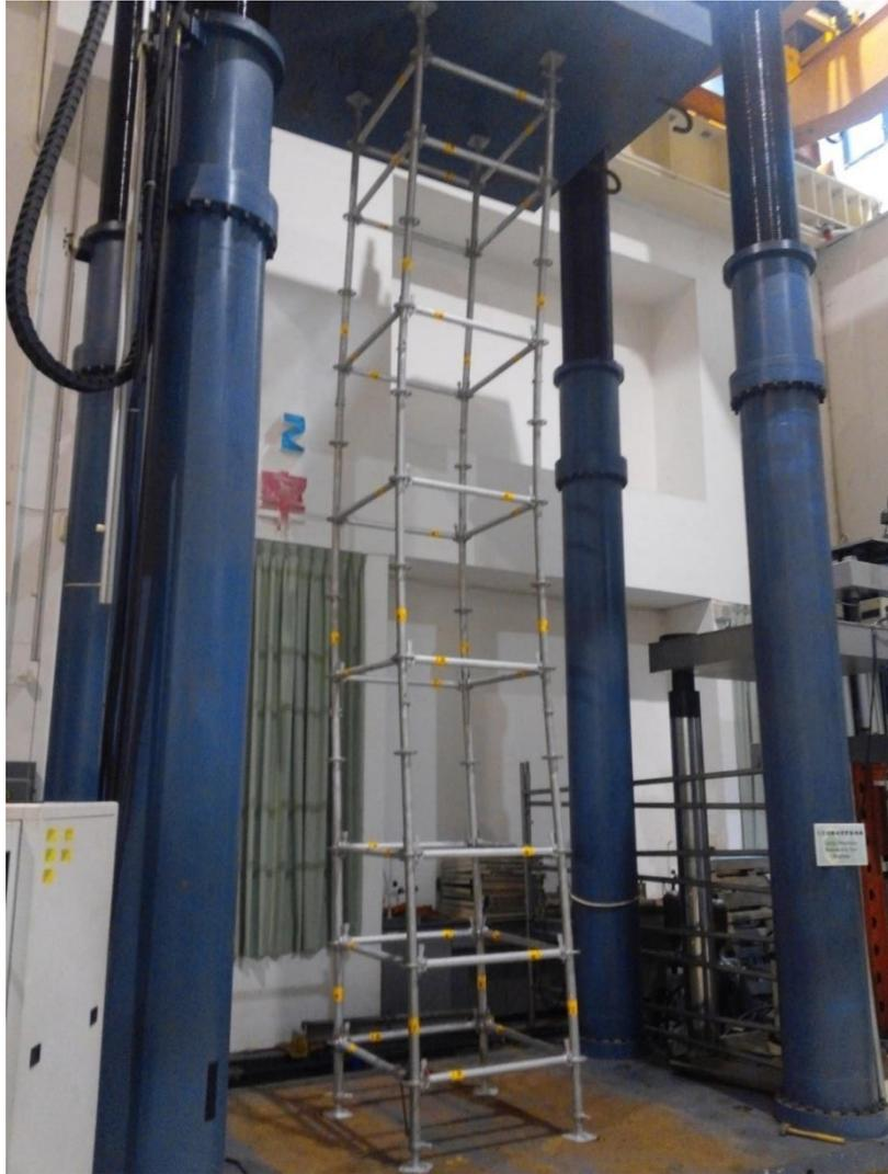
圖 20 輕型支撐架第加載試驗變形情形
