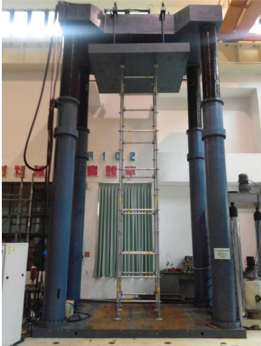
圖 19 輕型支撐架試驗設置情形
