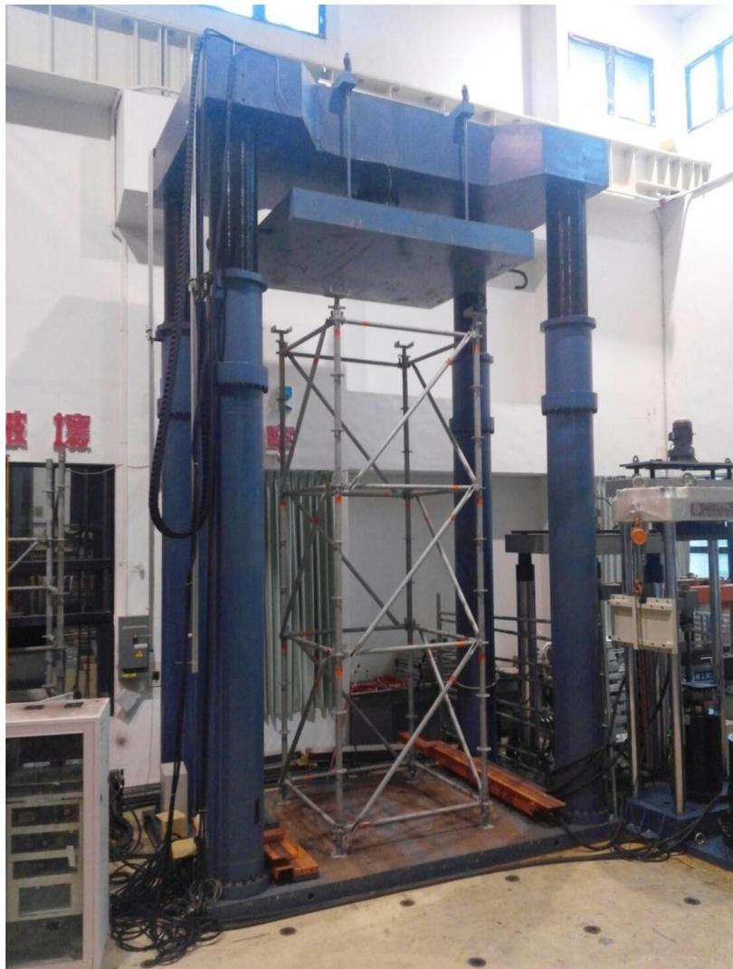
圖 15 重型支撐架試驗設置情形
