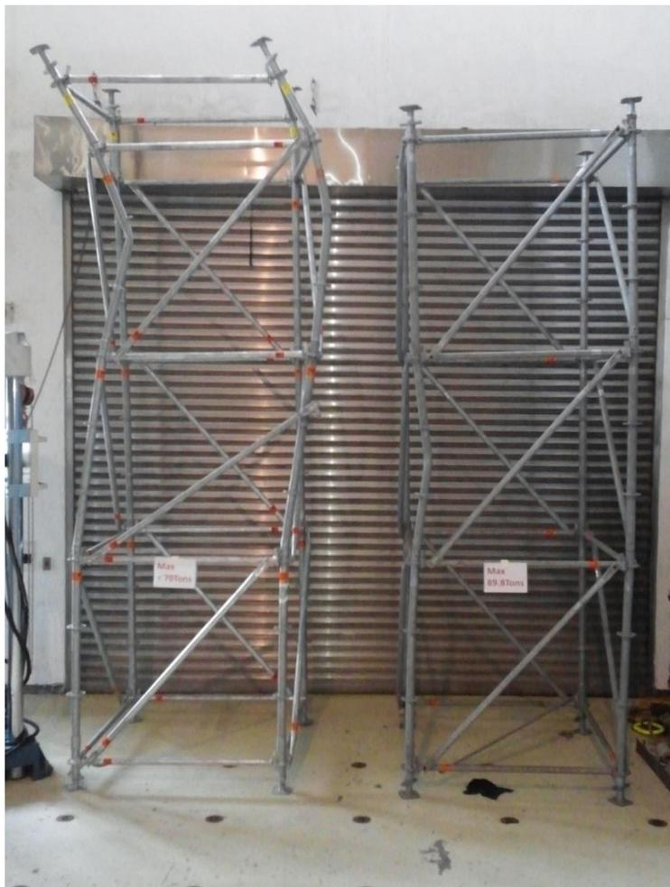
圖 17 重型支撐架試驗後變形，右方為標準型，左方為附調整層
