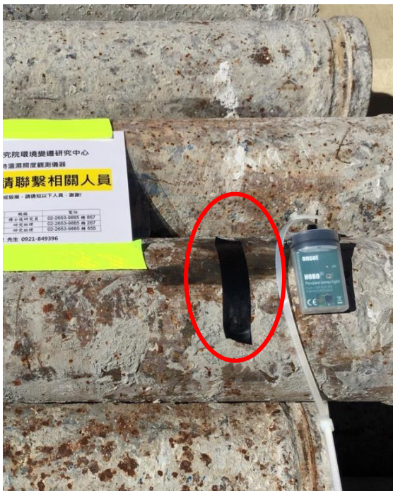
圖 81 絕緣膠帶貼於物料上(紅圈處)-1
