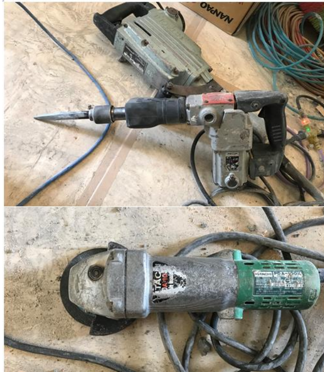
圖 4 拆除作業所使用之大小型電動鎚(上)與圓盤切割機(下)
