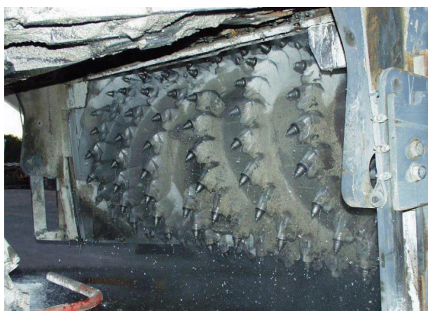
圖 5 水噴在滾筒來冷卻用來切割路面的鑽頭。當鑽頭切割路面時，水會和被移除的瀝青路面材料混合 (圖片來源 NIOSH)
