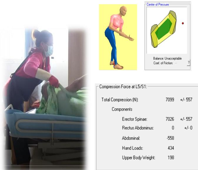
圖 11 3D-SSPP 模擬床對床徒手搬運之工作負荷
