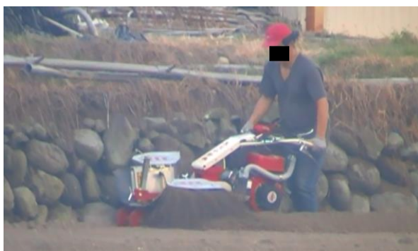
圖 1 推引開溝機之動作
