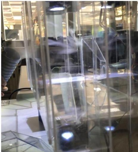
圖 120 第一組模型(改善後側吸式)煙霧流向
