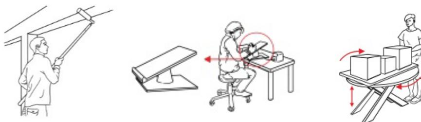
將工作台調整在適當的高度，使得作業點高度落在最佳作業區域、舒適作業區域、與有力抬舉區域是維持良好工作姿勢的不二法門，避免彎腰、蹲、跪、或過肩過頭、遠處前伸、後仰、側彎等等的不良工作姿勢。可是當工作狀況不允許的情形下，利用延長桿（管）可以避免聳肩及過頭作業姿勢；傾斜架可以降低低頭和彎腰；升降旋轉盤可以將工作物移近身體減緩彎腰、低頭與與手臂前傾。如此，可以使得肌腱、驅動手臂、手腕、與指頭的屈肌、伸肌、外展肌、內縮肌群（**flexor / extensor / abductor / adductor muscle groups**）均處於休息長度（**resting length**，或 **neutral length**）力量最小，很小的力量就能導致很大幅度的關節角度變化。反之，當手腕得關節角度處於屈曲、伸張、外展、或內縮的狀況下，互相拮抗的屈肌和伸肌以及外展肌和內縮肌群則都處於縮收的狀態，耗用體力。在此，關節的應力已經預先負荷（**pre-loaded**）的狀況下，關節活動肌肉必須產生更大的收縮才能維持姿勢穩定，
