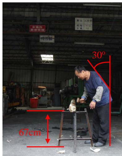
圖 4-3.1 作業員手持銅鎚敲打凝固的黏膠，使其與中心軸完全剝離
