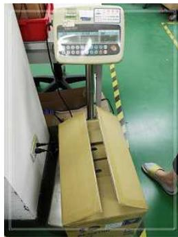
圖 2-2.1 庫房秤重作業：作業員徒手將料箱從旁邊搬至秤重機上秤重，秤重機顯示器高約 60 cm，作業員必須彎腰低頭確認顯示器上的數字
