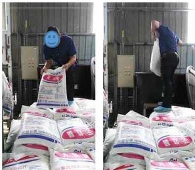
圖 2-4.1 廠務區入料：作業員由後方棧板抬起料包，轉身爬上階梯，一腳在下一腳在上，雙手拉取料包兩角，用力拉起將料包倒入桶槽。
