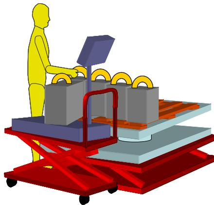
圖 1-4.3 利用油壓升降抬車提高料桶來減少人工抬舉的動作，並利用旋轉升降平台來降低彎腰的次數與搬運的距離。
