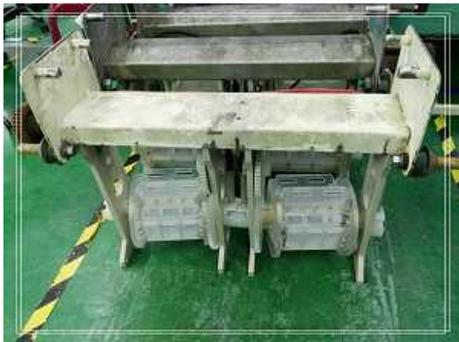
圖 2-3.1 電鍍鍍籠更換：作業員徒手搬運，過重。
