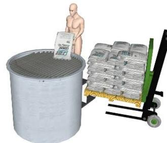
圖 2-4.3 桶槽加設 10 cm 柵條，作業員可直接將料包拉到桶槽上，直接割開料包入料。
