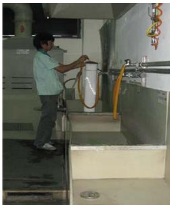
圖 5 作業員在沖洗槽洗淨燈管上之藥水
