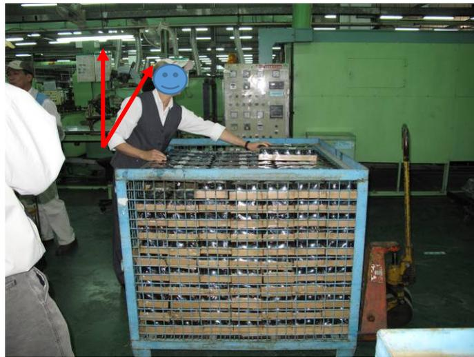
圖 3-2.2(b) 作業員將已包膜好的機油濾清器放入蝴蝶籠中
