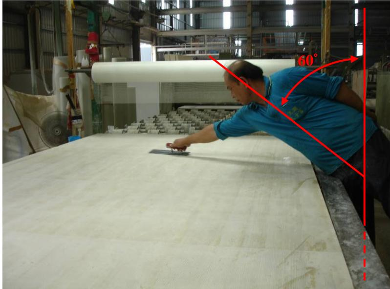
圖 6-2.3 對於在石板中央位置的補膠，作業員則必須俯身向前，同時伸長手臂，如此才能夠將補膠抹平，此時作業員身體的彎腰角度幾乎是 60 度以上，是一個相當勞累的作業。
