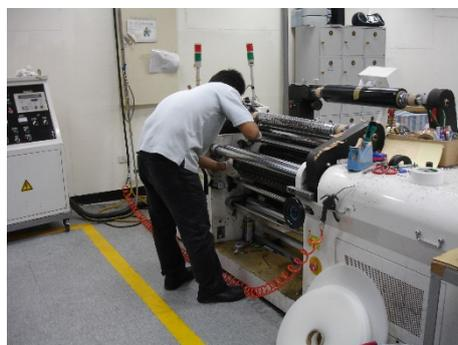
圖 4-4.2 作業員將刀具安裝於切割機(上刀)
