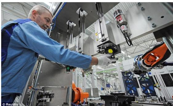
圖 3 設備、工具與零件部品皆設計在勞工伸手可觸的範圍，避免不良工作姿勢與不必要的動作
