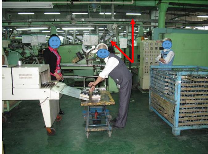
圖 3-2.1(a) 作業員將油壓升降台上包膜好的機油濾清器貼上不同廠商的標籤紙
