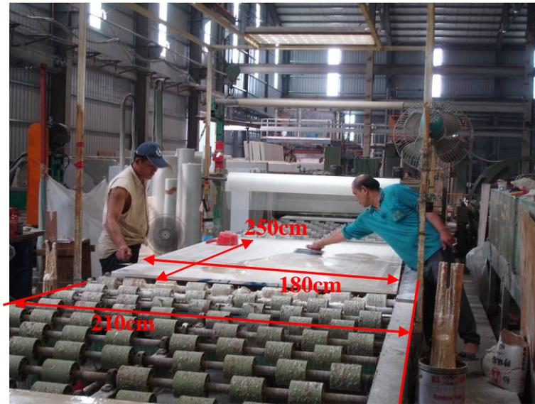
圖 6-2.2 兩側作業人員使用補膠刀將補膠均勻抹平於石板
