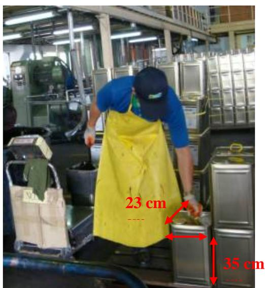
圖 1-4.2 作業員將裝滿油漆的鐵桶放置木板架上
