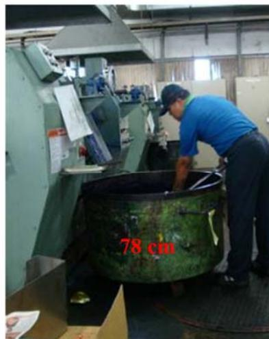
圖 1-3.1 作業員採站姿彎腰從顏料桶內鏟起原料
