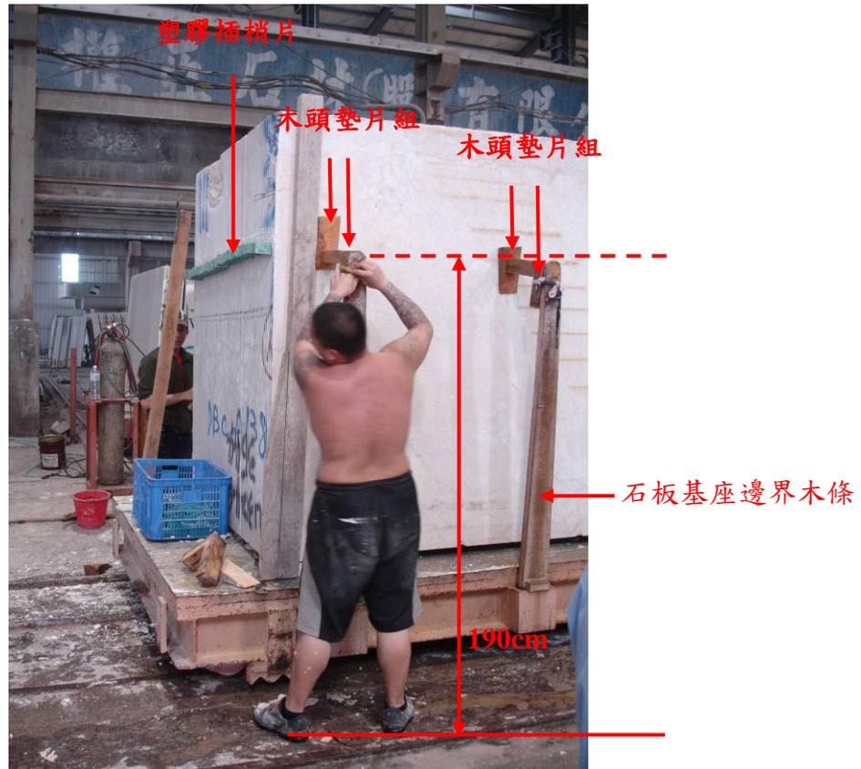
圖 6-1.1 石板群間的縫隙插入綠色塑膠插梢墊住，同時作業人員高舉手臂將木頭墊片組綁在石材基座的鋼條，由石板群兩側來夾住整個石板群。
