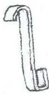
圖 3-1.2(a) 掛架前端設計成「S」型掛勾
