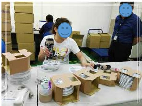
圖 2-5.1 庫房換標：作業員左手懸空握持吹風機，右手拿取 5 片電阻盤到面前，再以吹風機加熱後撕下標籤。
