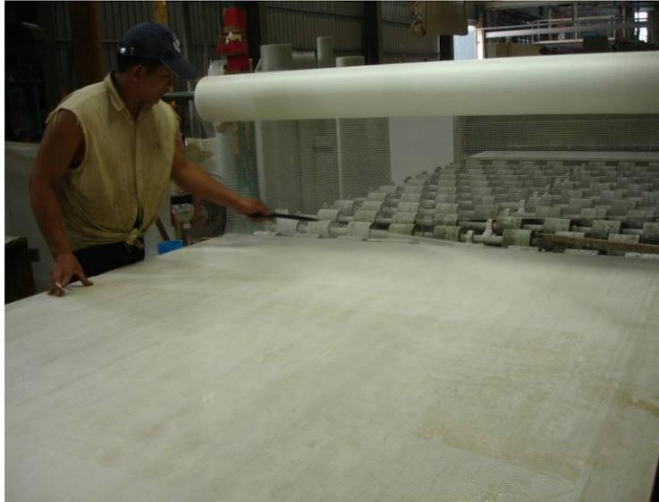
圖 6-2.1 作業人員將紗網由捲軸架上拉出，平鋪於石板並裁成適當長度
