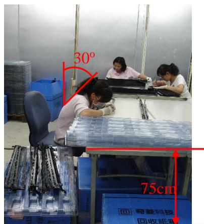
圖 4-1.1 作業員手持小刀將塑膠成品平整修邊
