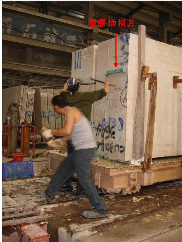
圖 6-1.5 作業人員將塑膠墊片移開
