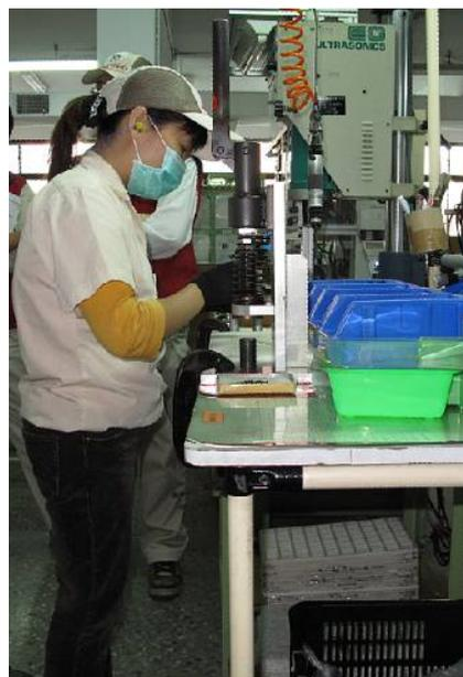
圖 3-6.1 溢油切斷作業
