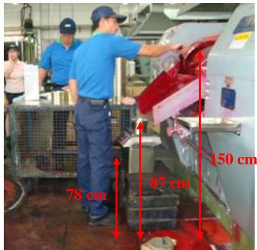
圖 1-2.1 1 公斤油漆罐裝作業作業員盛裝油漆至鐵罐內
