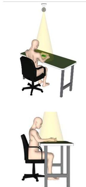
圖 2-1.2 改善示意圖：建議增設局部投射燈（照度高於周遭 3~10 倍），以及 15 度傾斜架
