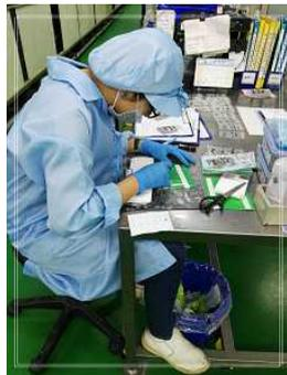
圖 2-1.1 外觀檢驗作業：作業員上身前傾、屈頸 45 度的姿勢檢查外觀。現場光線不足。
