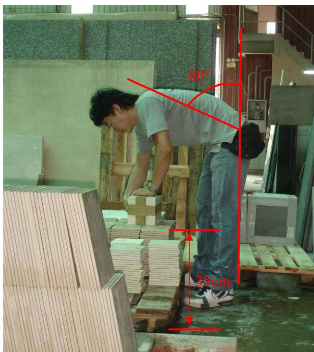
圖 6-6.1 作業人員利用膠帶以十字交叉的方式將二十片石板纏繞固定
