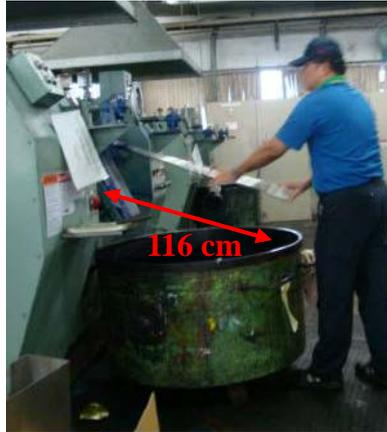
圖 1-3.2 作業員將長鏟舉起將顏料從顏料桶上料至機器
