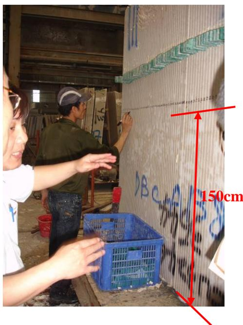
圖 6-1.2 石板分批前的石板編碼作業。作業員以手掌背屈的方式編寫流水號與箭號
