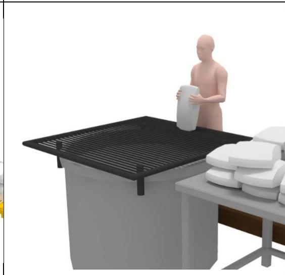
可以在混合槽開口上方增設一個柵欄。如此一來，作業員只要將鹽袋抬上並直接放置於混合槽上方柵欄。柵欄可以直接托著塑膠袋，讓作業員不必再花體力去平衡穩定鹽袋，而可以輕鬆從容的以美工刀割開袋底洩料，省卻體力。當然，更進一步地，如果可以在混合槽邊設置一個鹽袋的暫存架。此暫存架的高度約與混合槽柵欄一樣高。在加鹽作業前，可以先以堆高機將鹽袋放置於此暫存架上，高於柵欄，則作業員在進行作業時，他只要將鹽袋由暫存架上方直接拖拉到柵欄上面，那麼就連一開始抬舉鹽袋的施力都可以省卻。對作業員的體力負荷來說，更是相當大的節省。
