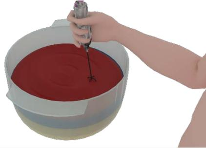
油墨調色作業是將紅、黃、藍、白、黑等原色油墨，依不同的比例混合以調製符合客戶的需求顏色與光澤。技術員在將各色顏料擠到一塊平板玻璃上，手持油墨刮刀徒手將之混合，混合均勻後以絹版在白紙上印製色塊樣板。由於油墨很黏稠，以刮刀混合顏料是一個耗費體力的工做，是手指必須用力、手腕必須不斷旋轉。技術員都是資深的員工，經常抱怨手部的酸痛與症狀。
