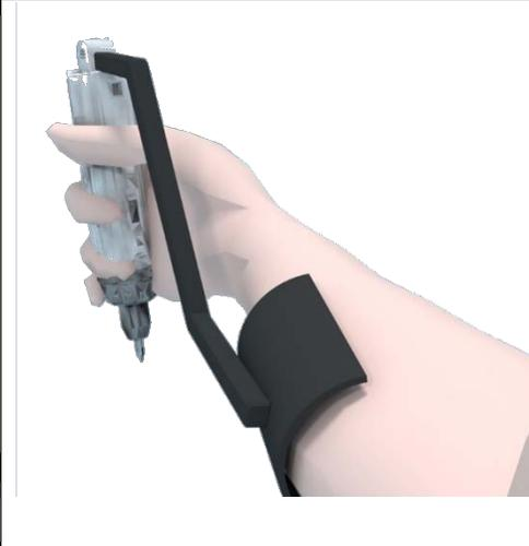
以氣動螺絲起子將螺絲鎖緊時，由於機器是以順時鐘的方向將螺絲旋入，因此會產生逆時鐘的反作用力，此反作用力會造成手臂逆時鐘的轉動，而作業人員會出順時鐘的力抵抗此逆時鐘的反作用力；然而，當螺絲快要鎖緊時，自動鎖螺絲機的力量會跟著變小，逆時鐘的反作用力跟著降低，此時，作業人員出順時鐘的力並沒有跟著減少，這樣一來，手臂容易瞬間過度用力且往順時鐘方向旋轉，造成手臂的肌肉骨骼疲勞與傷害。
