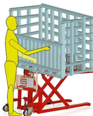
圖 3-2.2(b) 蝴蝶籠下方架置踏舉式油壓頂升拖板車
