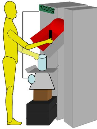
圖 1-2.2 將磅秤重量增加讀數顯示裝置上移至約與作業員眼同高的位置以避免作業員頻繁低頭的動作
