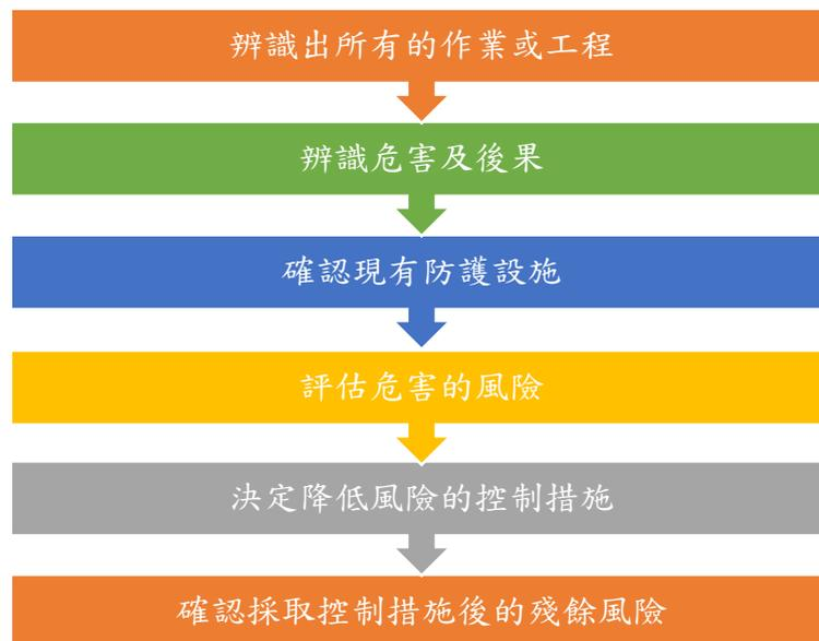
圖 14 風險評估的參考作業流程
