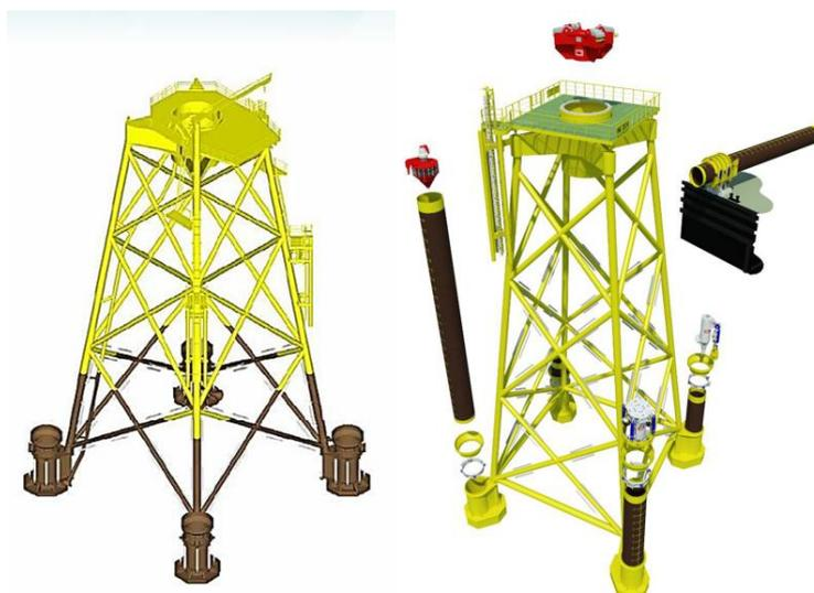
圖 12 後打樁之工序
