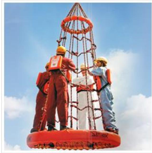
圖 38 人員運輸吊車(Personnel transfer basket)示意圖
