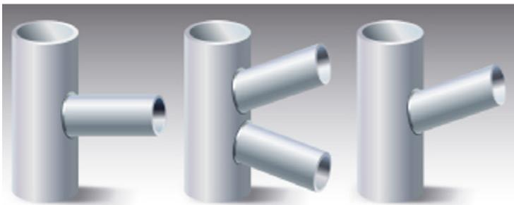
▲ 圖3. 管接頭T型、K型、Y型
